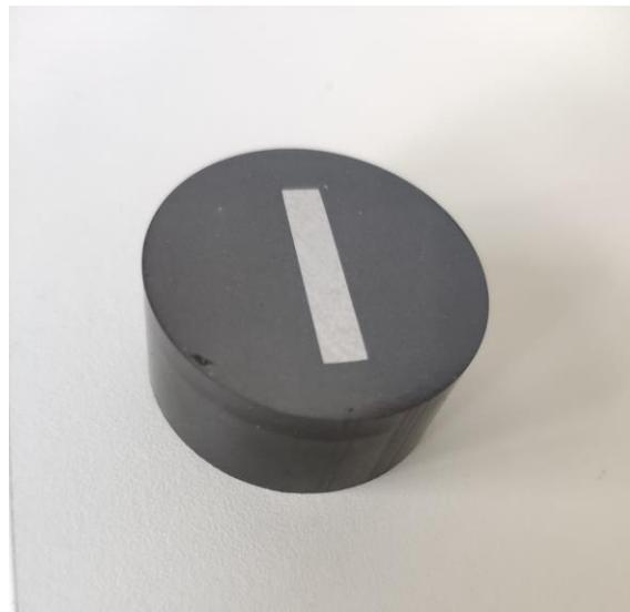
**Slika 25.**      **Pripremljen uzorak za ispitivanje mikrostrukture**
