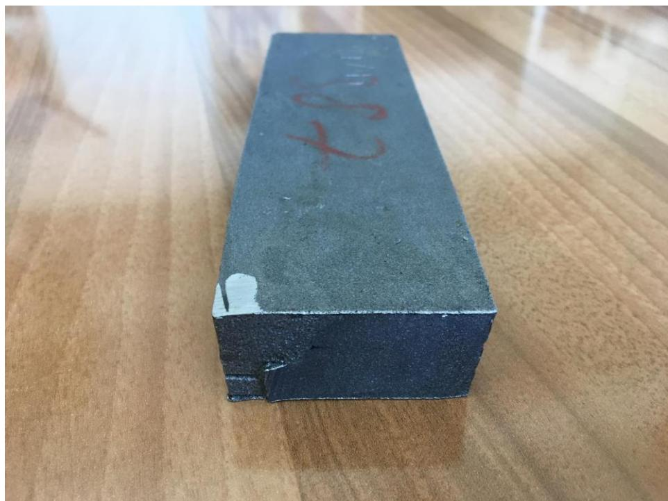
**Slika 18.**      **Odljevak lijeva oznake GX5CrNi 19-10**
