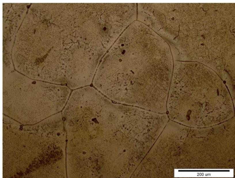
Slika 3. Mikrostruktura austenitnog nehrđajućeg čeličnog lijeva - 100% austenit [5]
