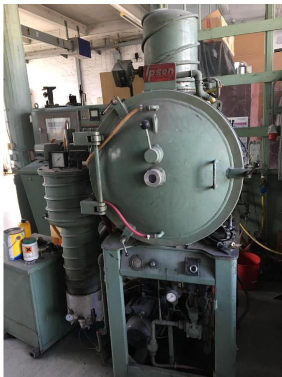
Slika 20. Vakuumska peć
