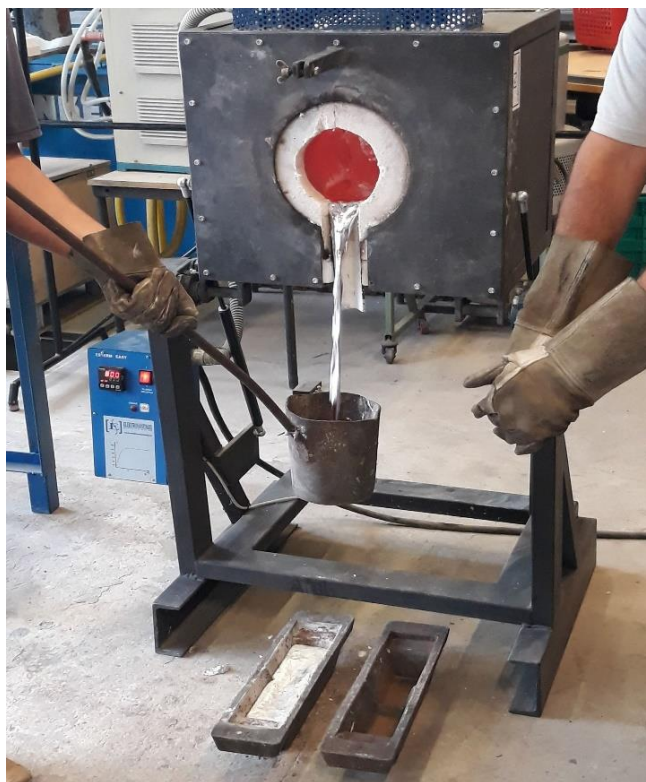
Slika 48. Ulijevanje taljevine u lonac za lijevanje.
