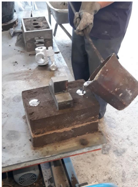
Slika 50. Ulijevanje taljevine u kalup.
