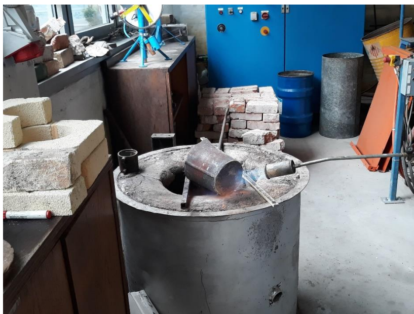
Slika 46. Zagrijavanje lonca za lijevanje taljevine.
