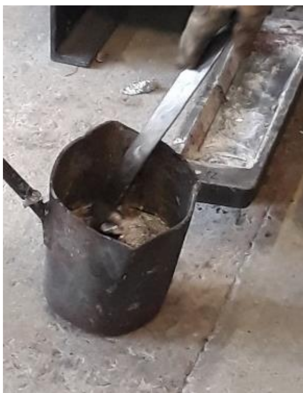
Slika 49. Čišćenje aluminijskih oksida sa površine taljevine.
