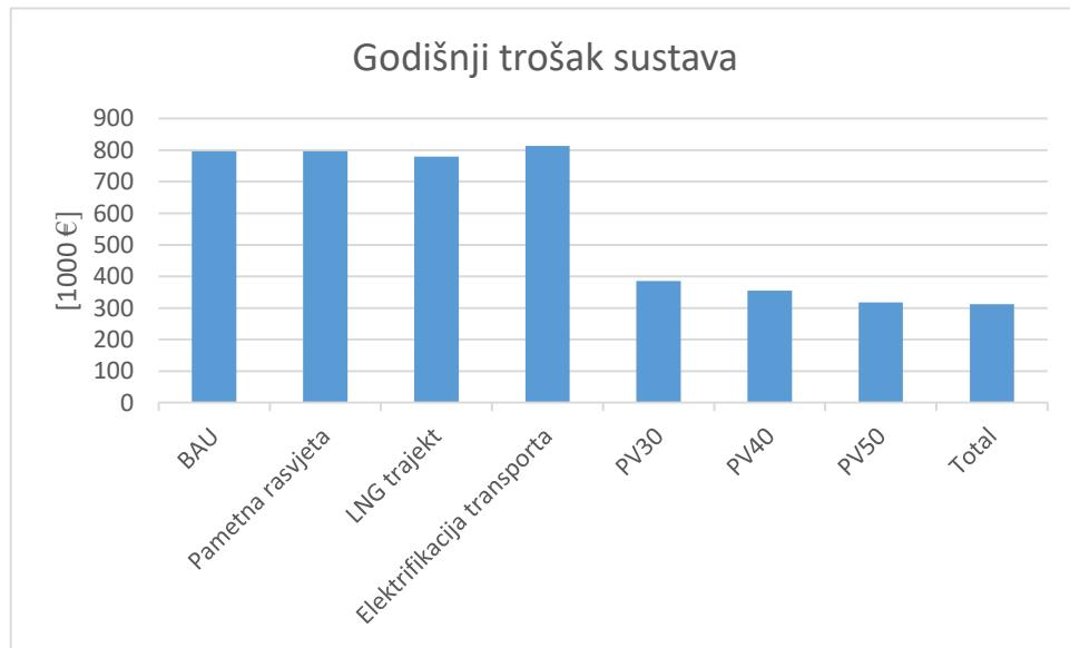
Dijagram 34. Usporedba simuliranih modela po godišnjem trošku sustava
