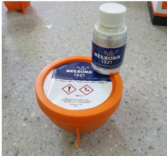
Slika 7.7. Belzona 1321 (Ceramic S-Metal) epoxy premaz
