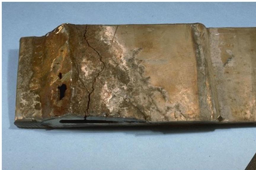
Slika 2.8. Napetosna korozija visokolegiranog čelika [5]
