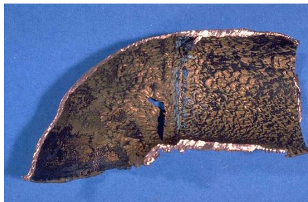
Slika 2.7. Erozijsko-korozivna oštećenja tipa "potkovića" u bakrenom cjevovodu [5]
