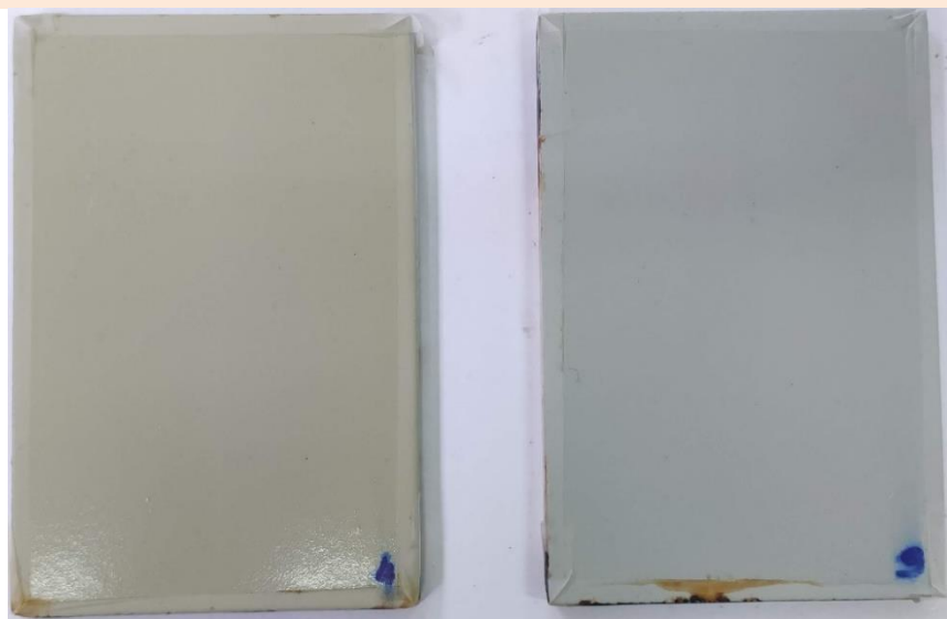
Slika 5.39. Uzorci nakon 384 i 720 h provedenih u vlažnoj komori
