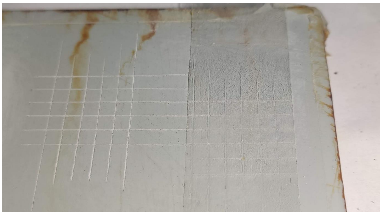
Slika 5.49. Rezultat Cross cut ispitivanja na uzorku broj 2
