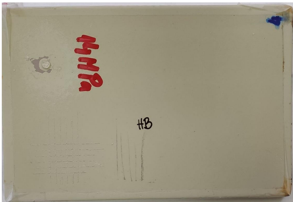
Slika 5.44. Rezultat mjerenja tvrdoće premaza olovkama na uzorku broj 4
