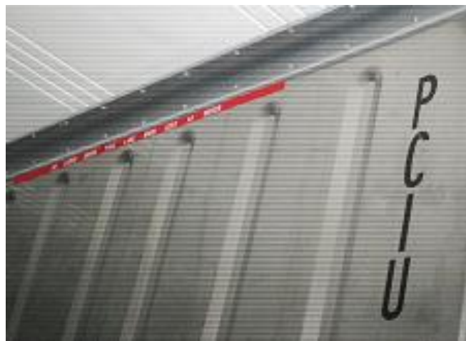
Slika 11. Prikaz linije punjenja rashladnih kontejnera [16]
