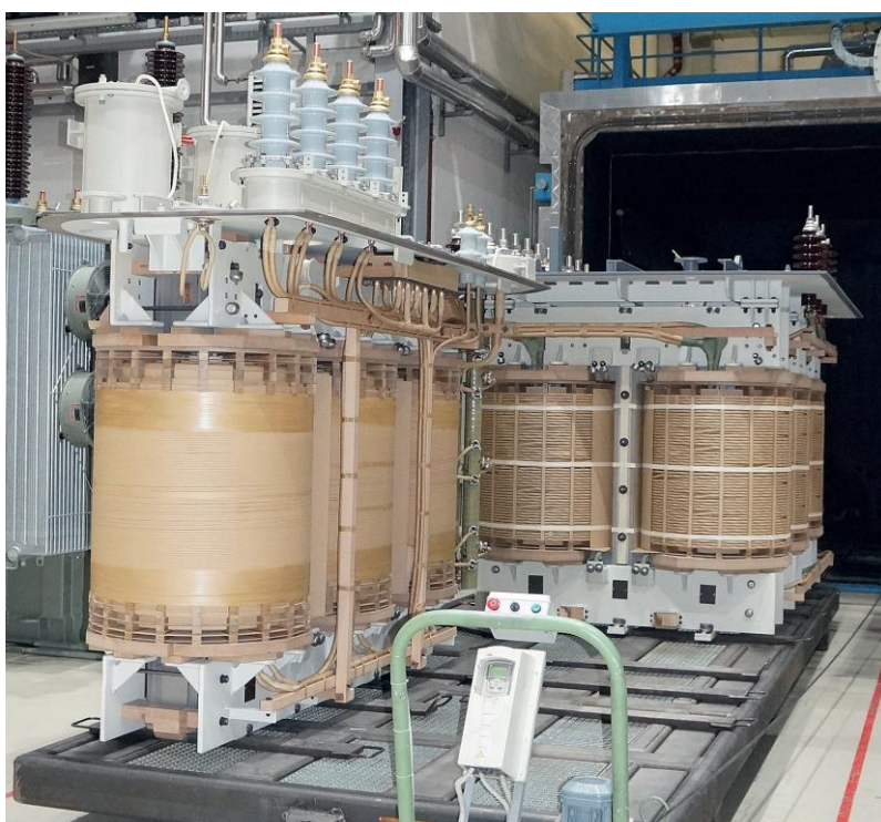
Slika 6. Celulozna izolacija omotana oko aktivnih dijelova [15]
