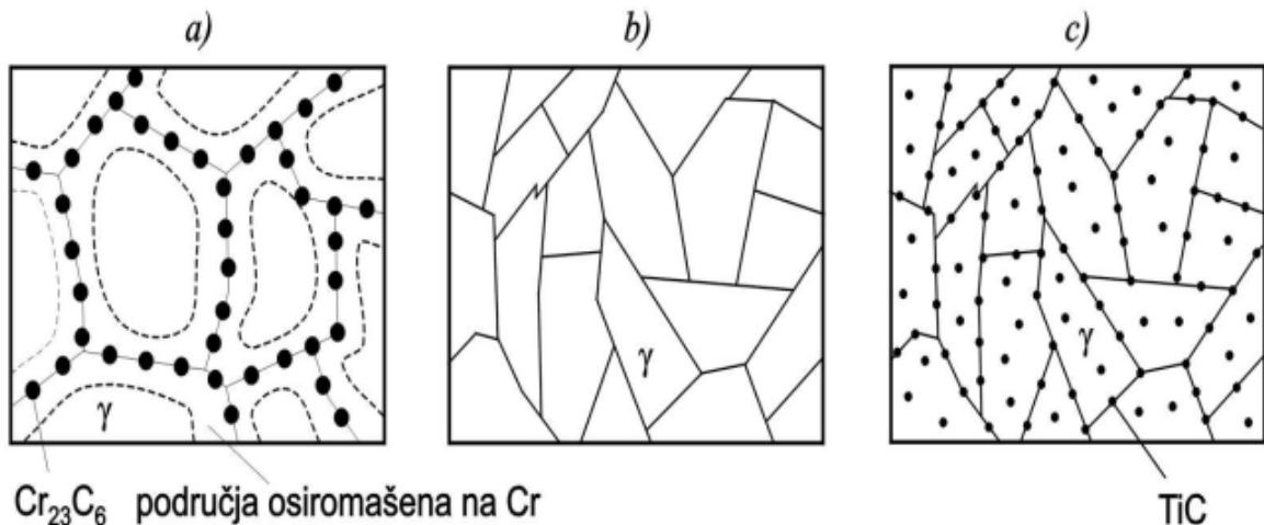
**Slika 15. Shematski prikaz senzibiliziranog čelika, čelika sa smanjenim udjelom ugljika i stabiliziranog čelika [3]**
