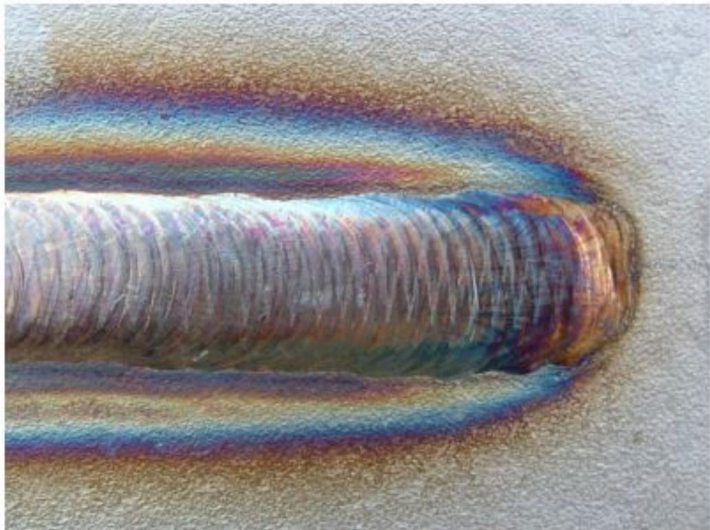
**Slika 17. Obojenja površine nastala unosom topline postupkom zavarivanja [6]**
