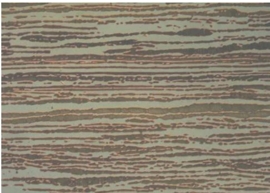
Slika 7. Mikrostruktura dupleks čelika [3]
