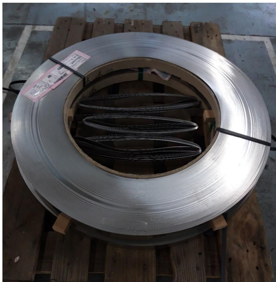
Slika 21. Polazni kolut lima za izradu cijevi
