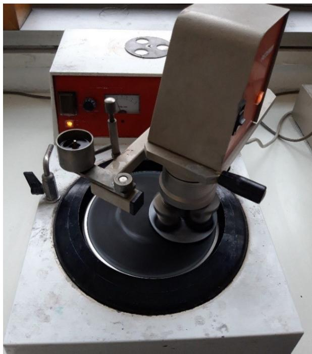
**Slika 42. Poliranje uzorka**
