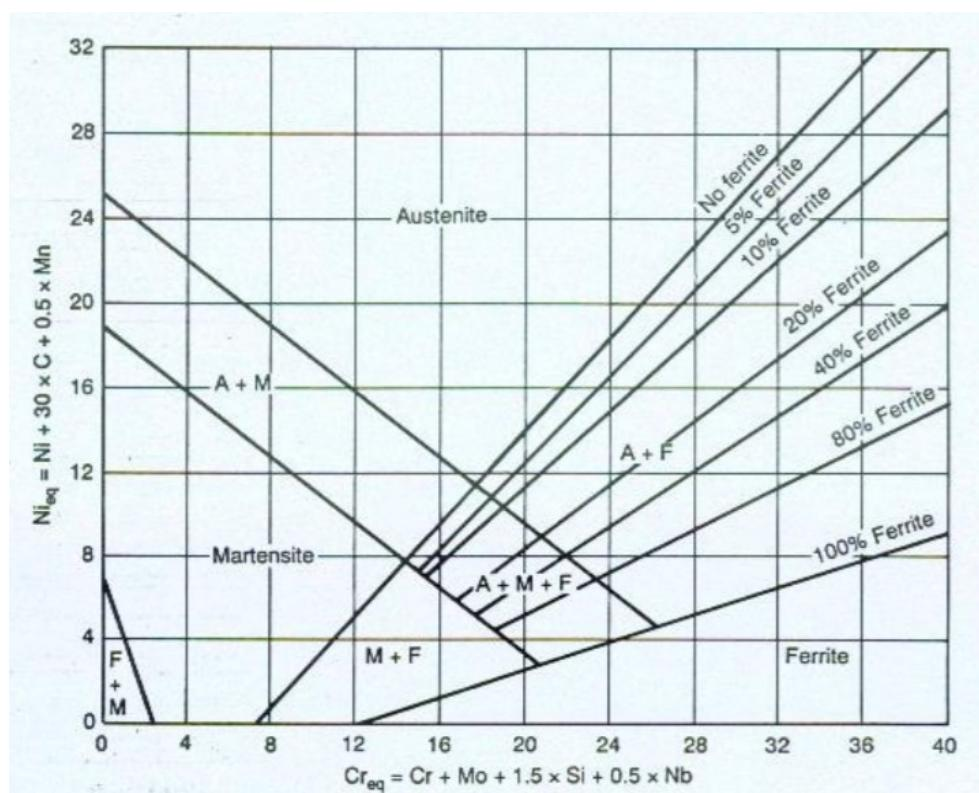
Slika 4. Smještaj nehrđajućih čelika u Schaefflerovom dijagramu [3]
