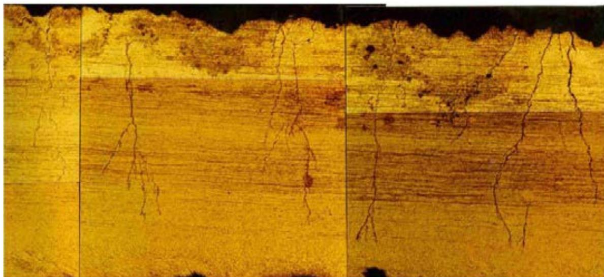
Slika 16. Transkristalna napetosna korozija austenitnog čelika X5CrNi18-8 [6]
