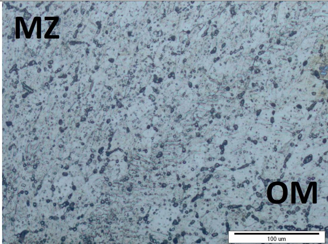
Slika 52. Mikrostruktura ZUT-a nakon rastvornog žarenja;  $v=0,6$  m/min
