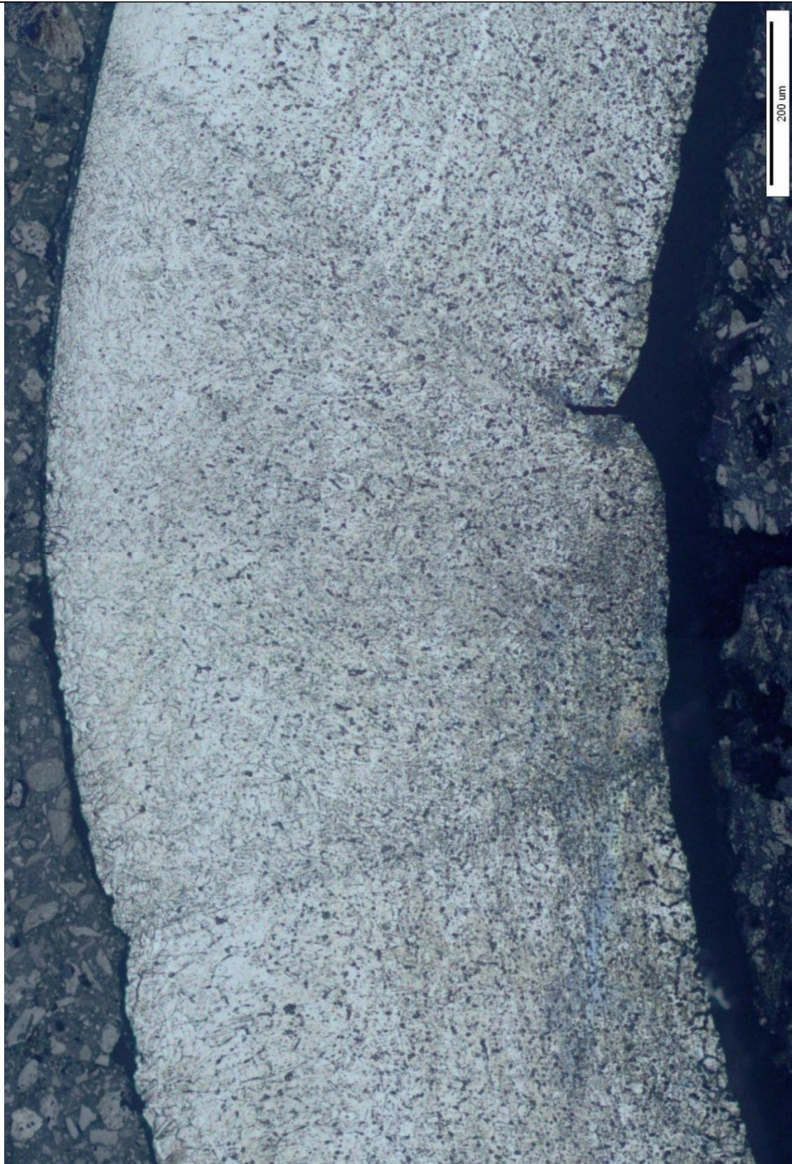
**Slika 64. Mikrostruktura zavarenog spoja nakon rastvornog žarenja;  $v=1,10 \text{ m/min}$  pri većem povećanju**
