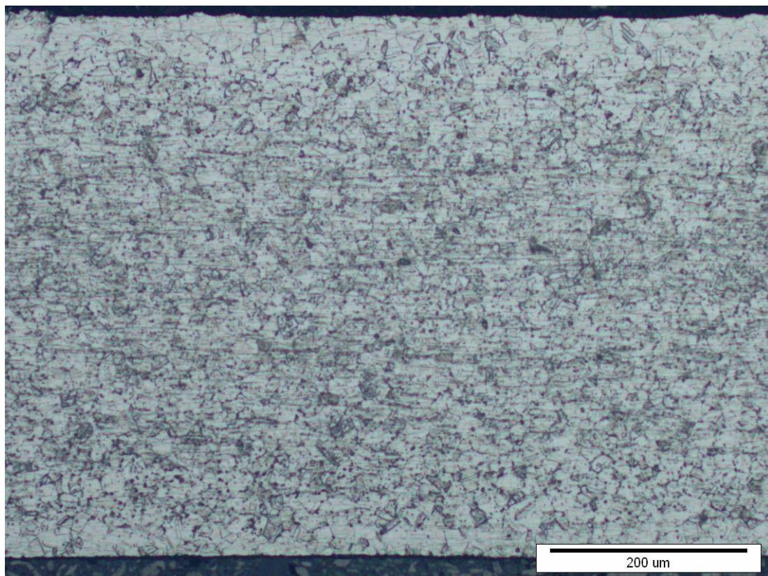
Slika 43. Mikrostruktura lima u nagriženom stanju, poprečni presjek
