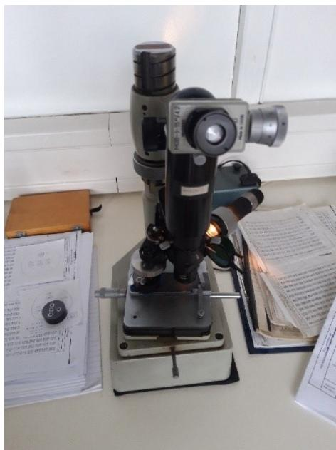
Slika 71. Mikrotvrdomjer PMT3
