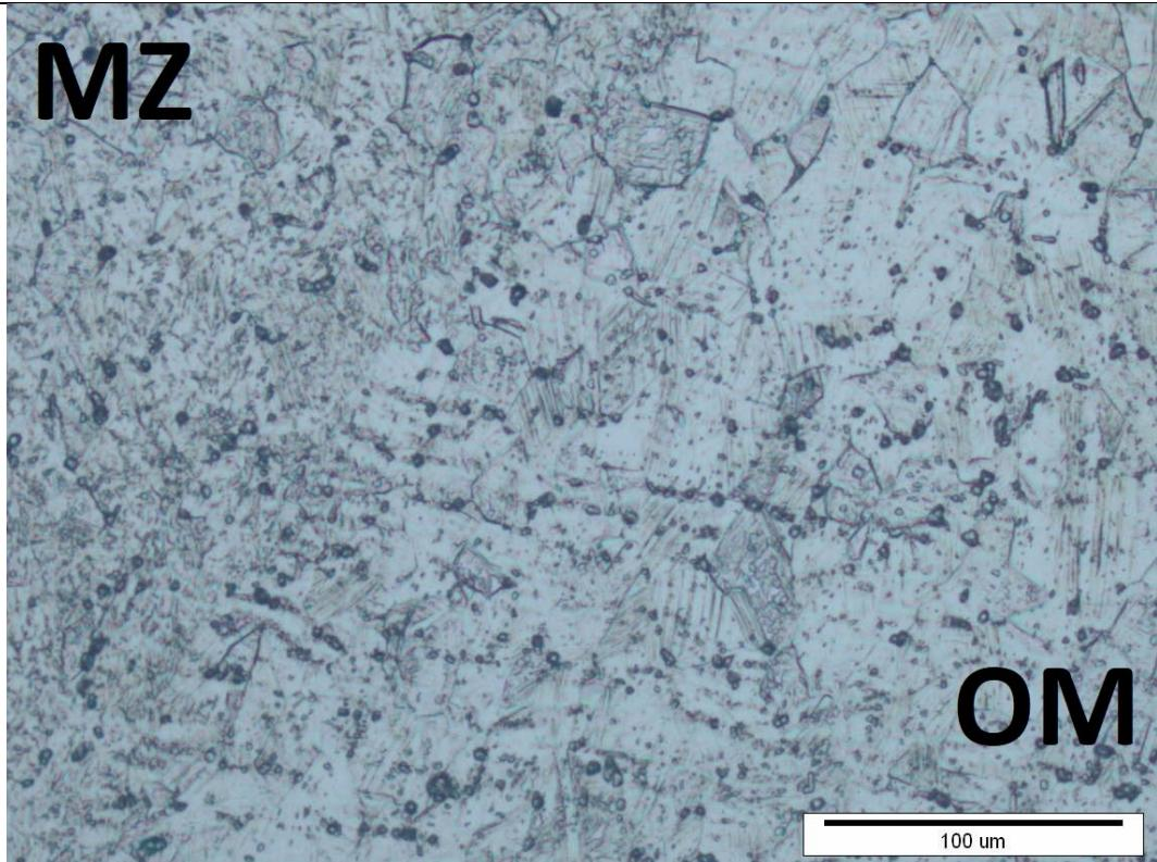
Slika 56. Mikrostruktura ZUT-a nakon rastvornog žarenja; v=0,85 m/min
