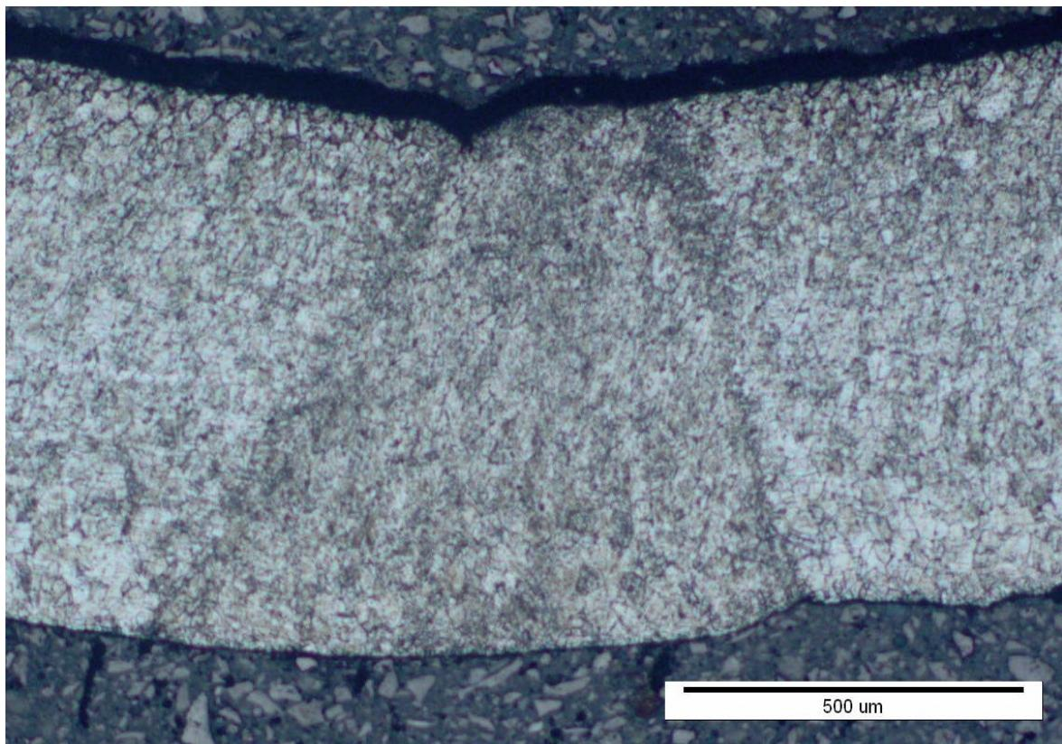
Slika 54. Mikrostruktura zavarenog spoja nakon rastvornog žarenja;  $v=0,85 \text{ m/min}$
