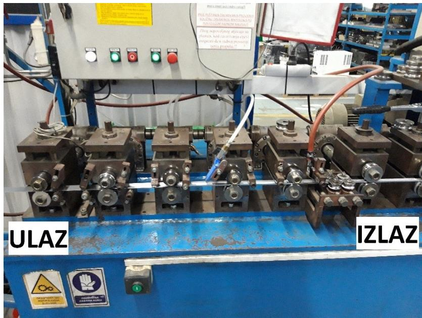
**Slika 22. Sustav profiliranih valjka za oblikovanje cijevi**
