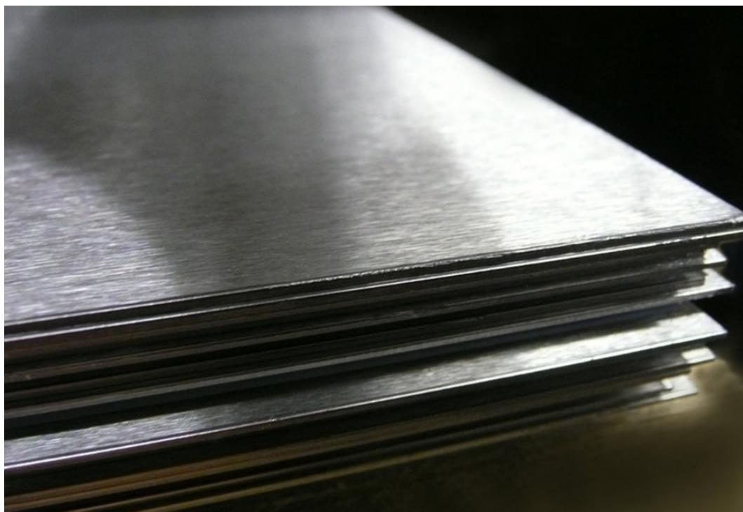
Slika 12. Limovi od čelika X5CrNi18-8 (AISI 304) [14]
