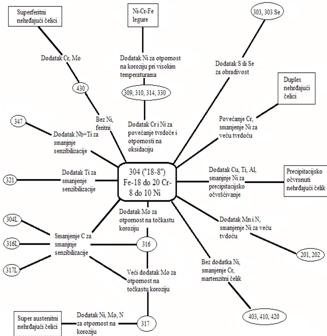
Slika 11. Shematski prikaz razvoja različitih vrsta nehrđajućih čelika [11]
