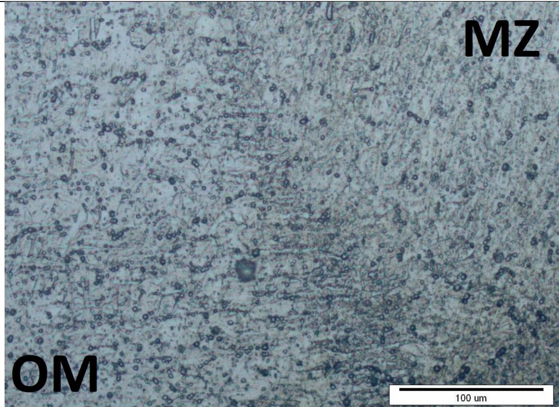
Slika 69. Mikrostruktura ZUT-a nakon rastvornog žarenja;  $v=1,20$  m/min
