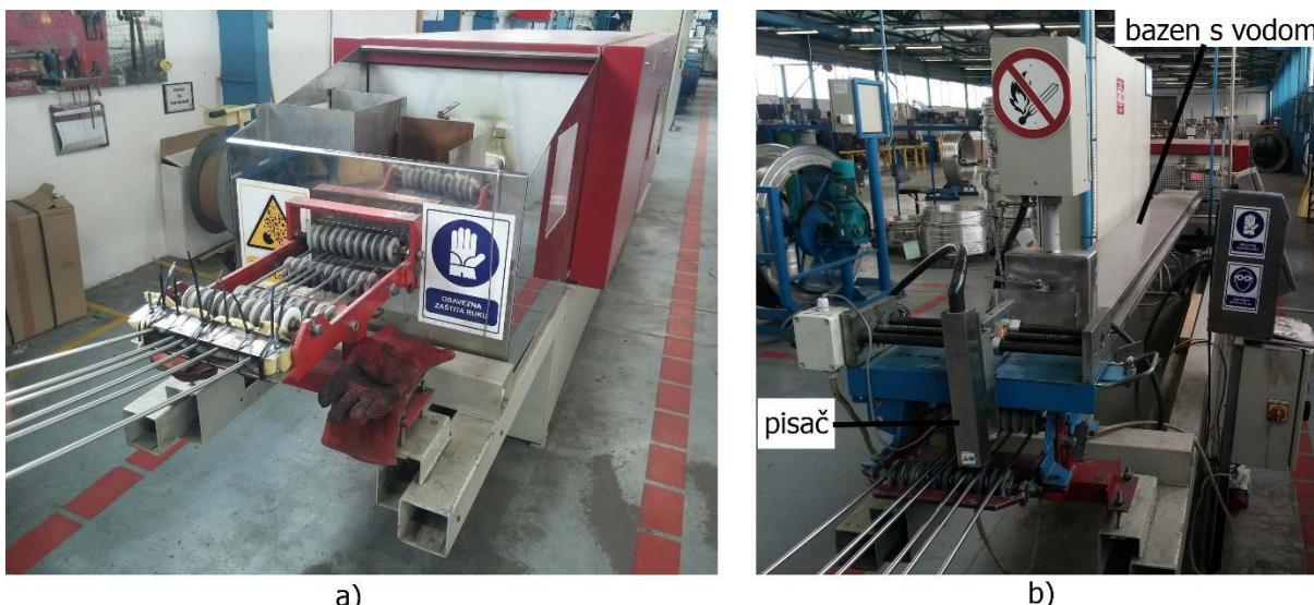
Slika 34. Ulaž cijevi u peć (a) te pisač (b) [10]
