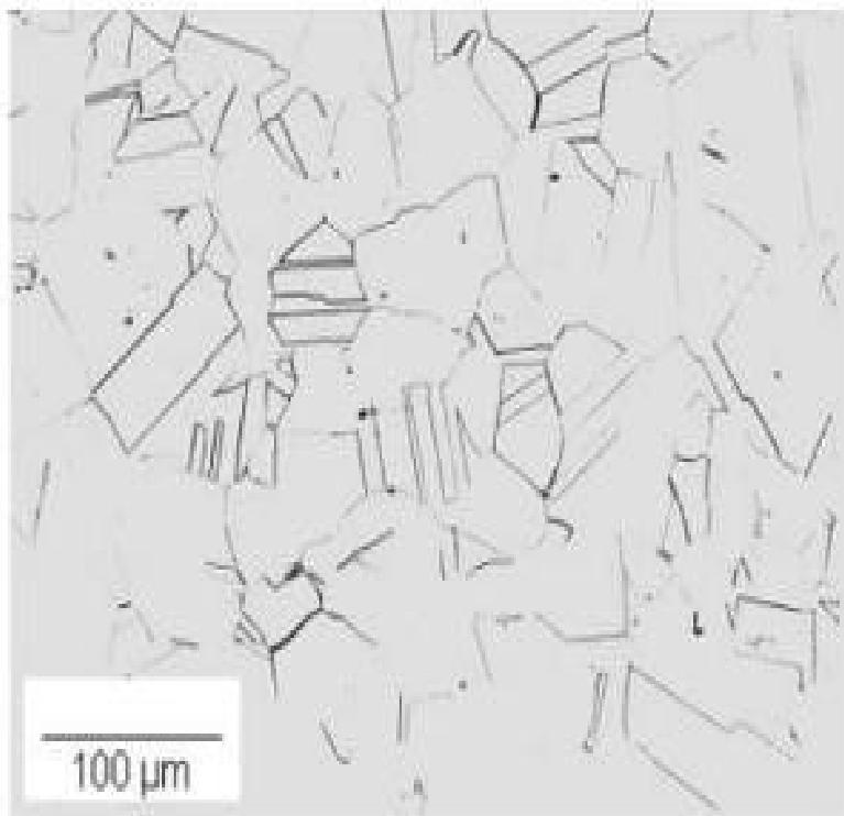
**Slika 8. Mikrosturktura austenitnog nehrđajućeg čelika [5]**
