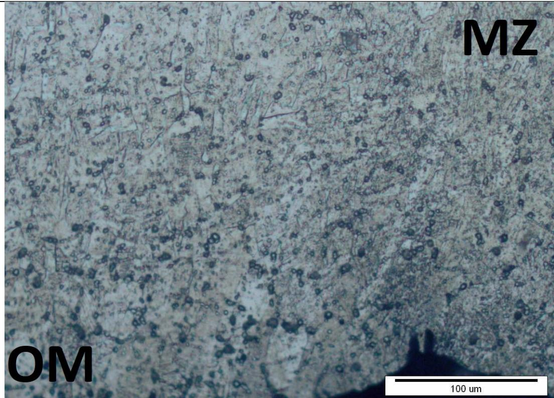
Slika 61. Mikrostruktura ZUT-a nakon rastvornog žarenja;  $v=1,00$  m/min
