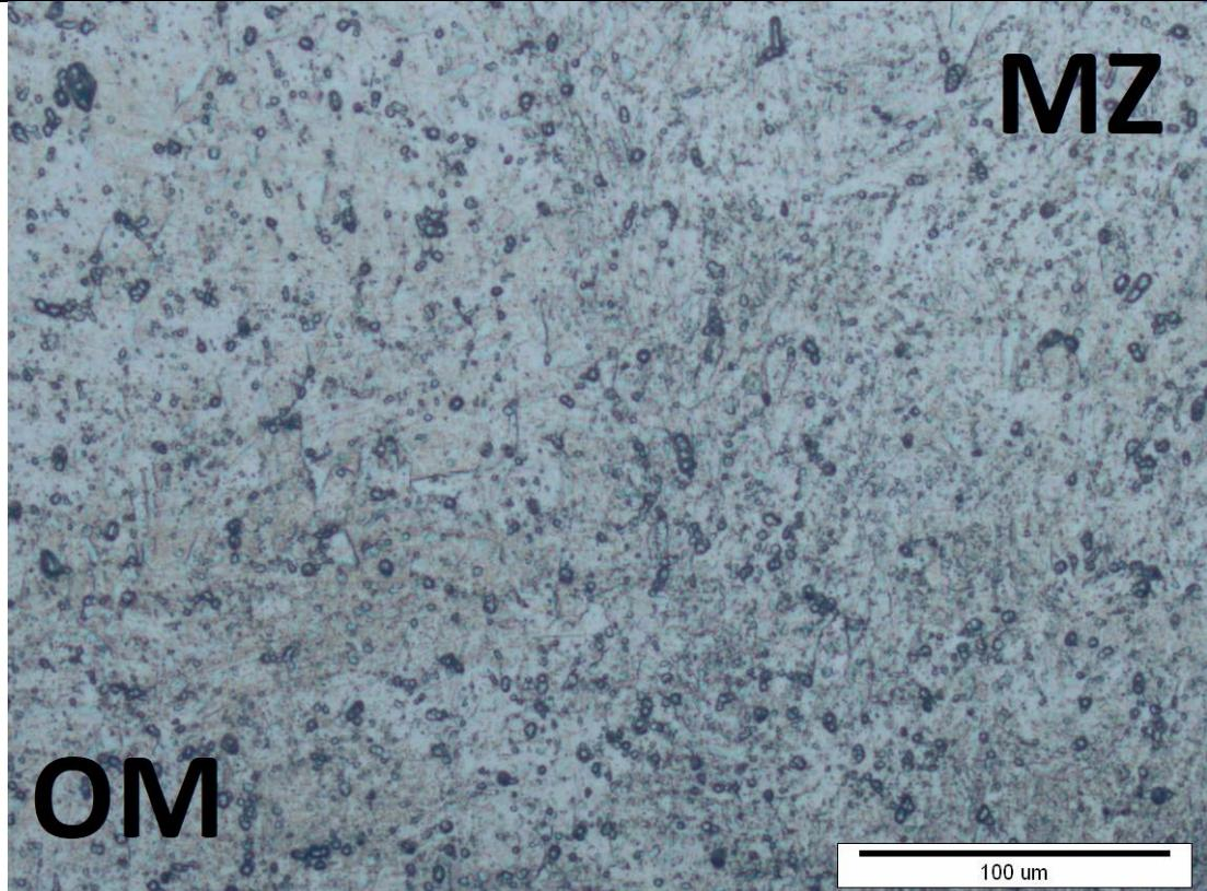
Slika 65. Mikrostruktura ZUT-a nakon rastvornog žarenja;  $v=1,10$  m/min
