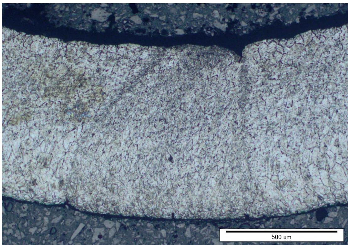
**Slika 50. Mikrostruktura zavarenog spoja nakon rastvornog žarenja;  $v=0,6\text{ m/min}$**
