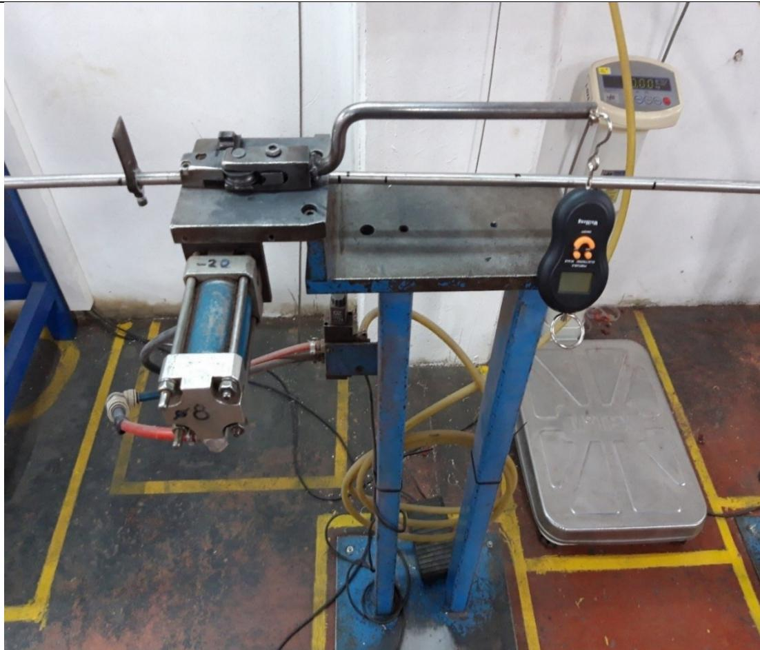
Slika 73. Naprava za ručno savijanje cijevi
