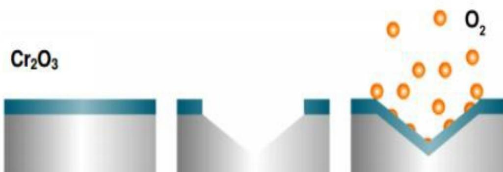
Slika 2. Samoobnavljanje pasivnog filma kromovih oksida na nehrđajućem čeliku [4]
