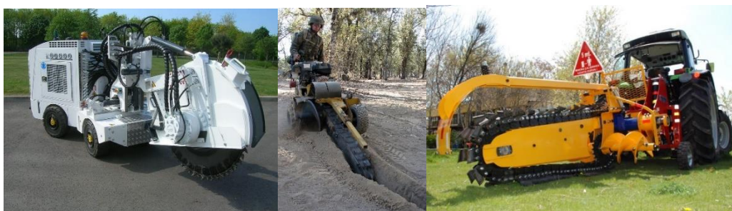
Slika 2.3. Primjeri mikro, prijenosnog i traktorskog rovokopača [6]
