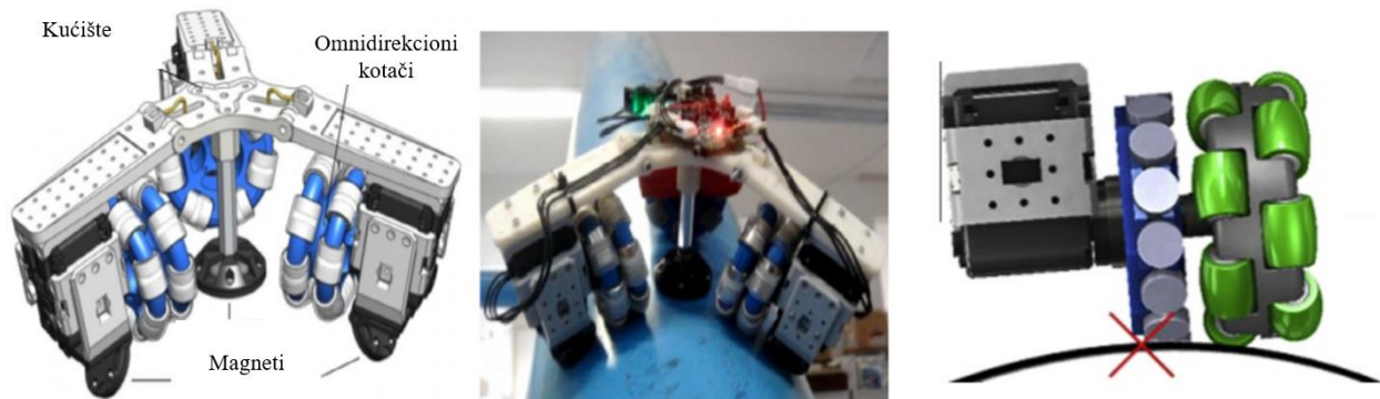
Slika 9. Omniclimber četvrte generacije: sklop (lijevo), adhezija na stupu (sredina), problem naginjanja (desno) [12]
