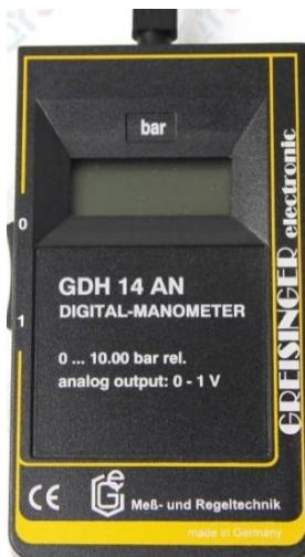
Slika 31. Digitalni manometar Greisinger digital manometer GDH 14
