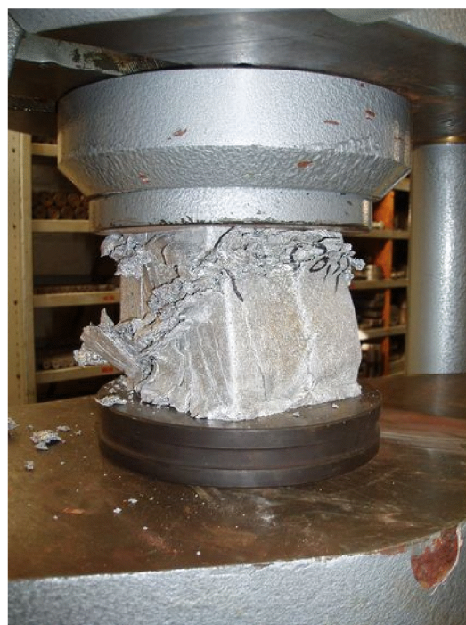
Slika 6.17. Završetak ispitivanja je točka kod koje dolazi do potpunog sabijanja gdje sila počinje eksponencijalno rasti.
