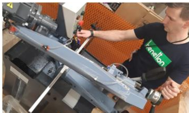
Slika 7.21. Rezanje pleksiglasa na gabaritne mjere (lijevo) i rezanje aluminijskih profila na definirane dimenzije (desno)
