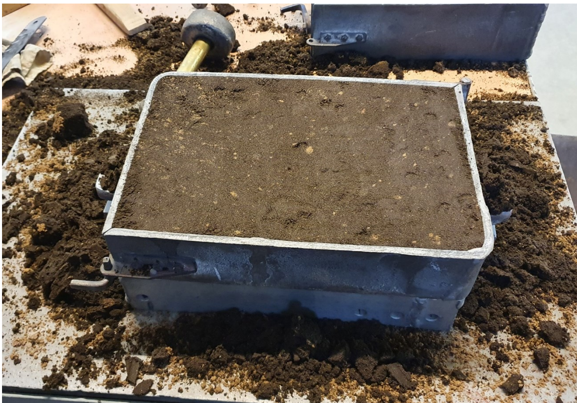
Slika 29. Donjak nakon sabijanja i poravnavanja kalupne mješavine
