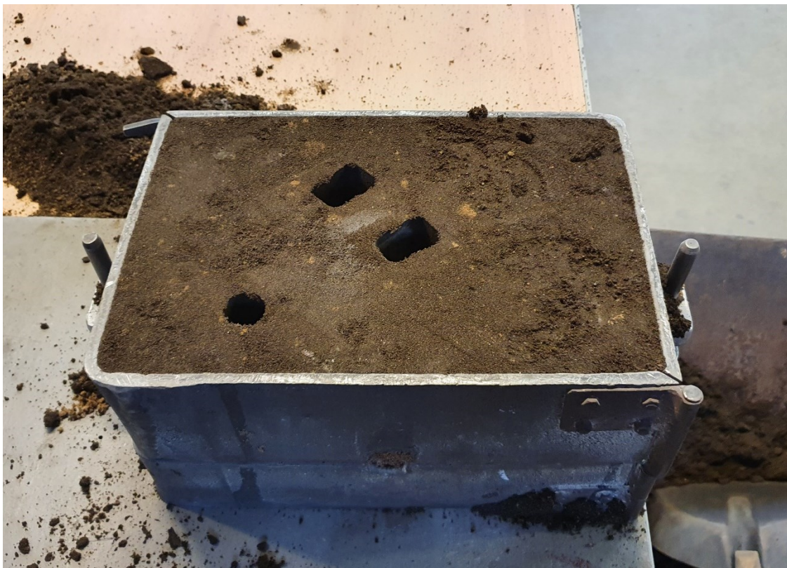
Slika 34. Gornjak nakon vađenja spusta i pojila
