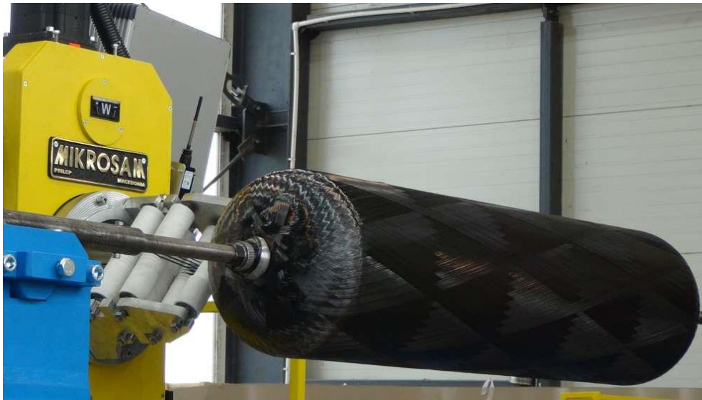
Slika 13. Namatanje ugljičnih vlakana [17]
