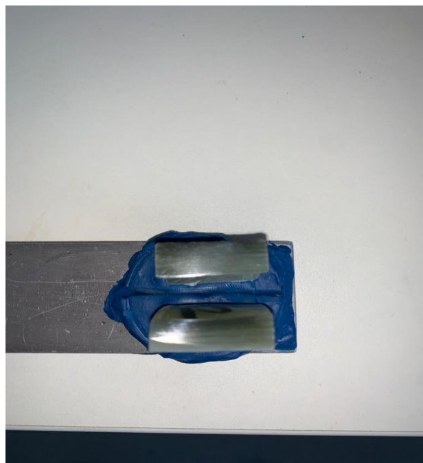
Slika 30. Uzorci nakon poliranja i brušenja
