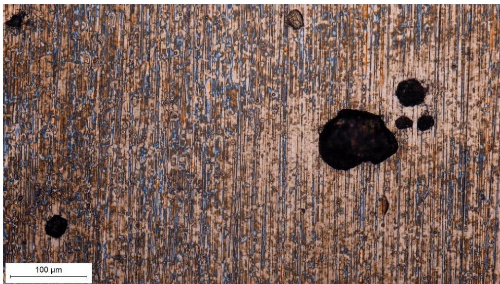
Slika 39. Trošene površine uzorka D2 od čelika K110 snimljene na svjetlosnom mikroskopu
