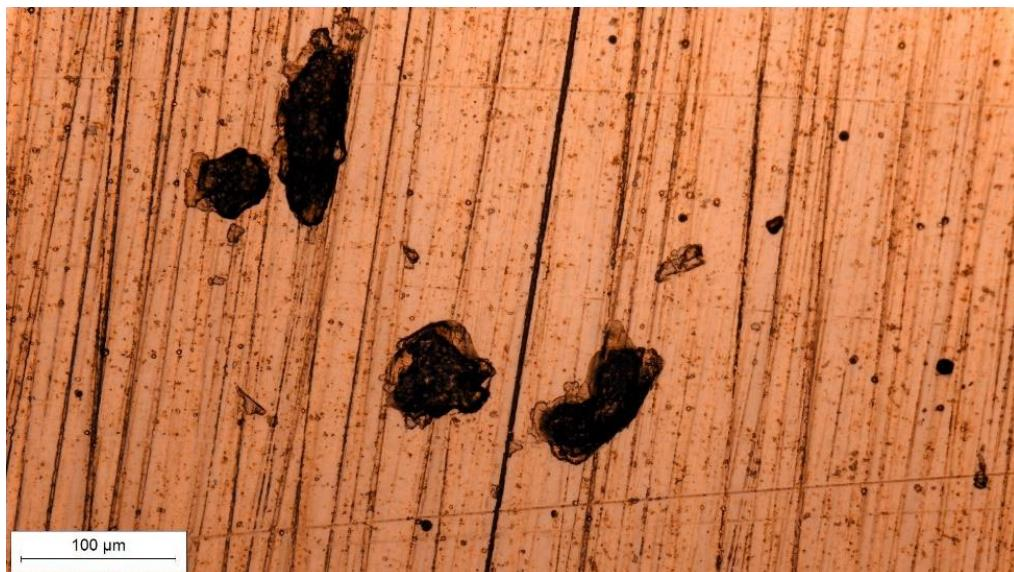
**Slika 43. Trošene površine uzorka C3 od čelika K390 MC snimljene na svjetlosnom mikroskopu**
