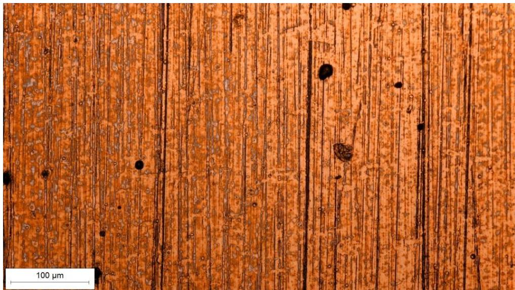
Slika 40. Trošene površine uzorka D3 od čelika K110 snimljene na svjetlosnom mikroskopu
