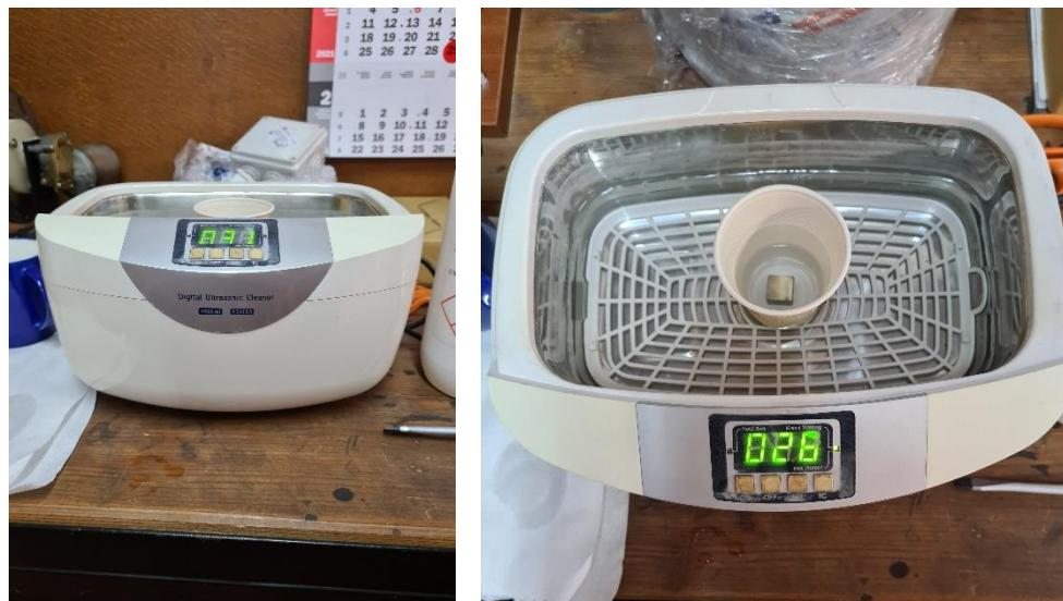
Slika 20. Ultrazvučna kupka: a) prednji pogled, b) pogled odozgo (sa uzorkom)
