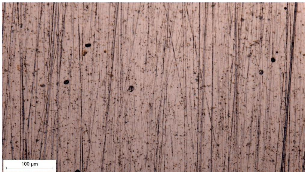
**Slika 42.. Trošene površine uzorka C2 od čelika K390 MC snimljene na svjetlosnom mikroskopu**
