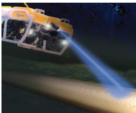
Slika 10.15 Daljinski upravljana podmornica sa ugrađenim flourometrom [45]
