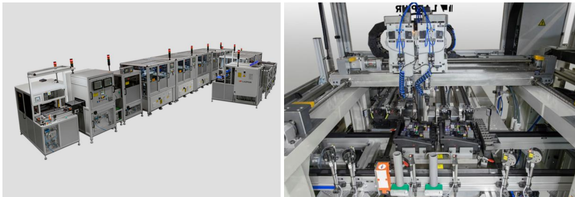
Slika 3. Proizvodna linija za montažu kućišta osigurača tvrtke Laziur [3]
