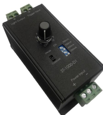
Slika 51. Kontroler za upravljanje industrijskim osvetljenjem [14]
