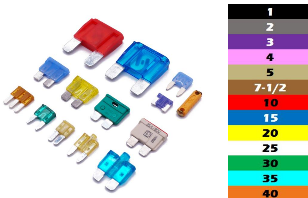
Slika 1. Različite vrste osigurača (lijevo) i vrijednost struje koju osigurač može provesti ovisno o boji osigurača [2]
