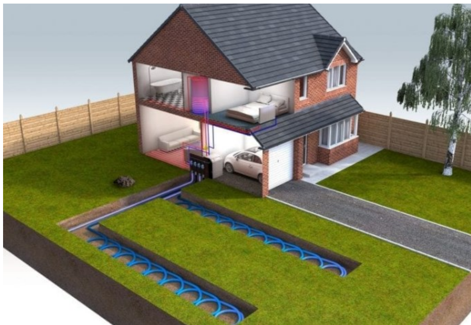
Slika 7. Horizontalno polaganje izmjenjivača topline [9]
