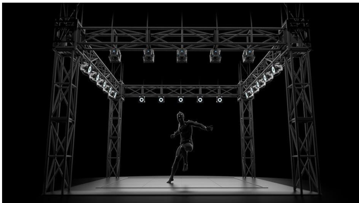
Slika 9. Optički sustav za snimanje [15]
