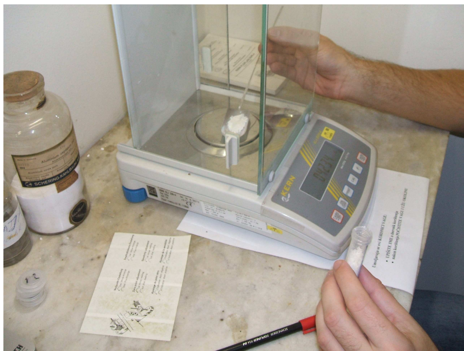
Slika 3.1. Određivanje masenog udjela pojedinih elemenata u suspenziji.
