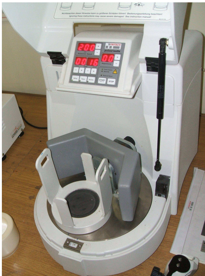
Slika 3.2. Planetarni kuglični mlin (Pulverisette 6, Fritsch, Germany).
