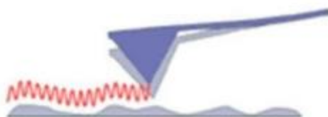
Slika 16. Shematski prikaz rada beskontaktna metode AFM-a [32]
