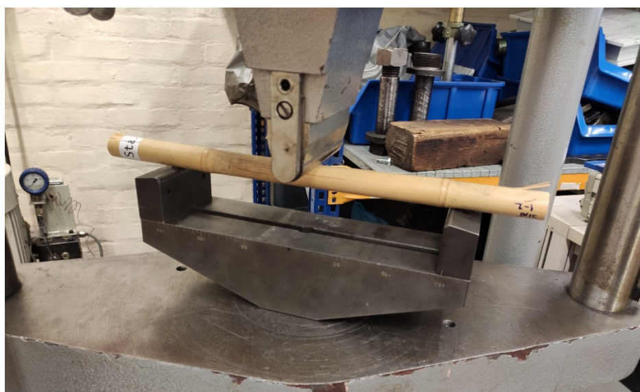
Slika 29. Uzorak tijekom statičkog ispitivanja savijanjem u tri točke
