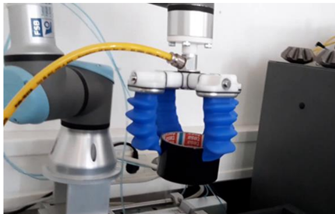
Slika 9. Primjer hvatanja predmeta mGrip mekanom hvataljkom
