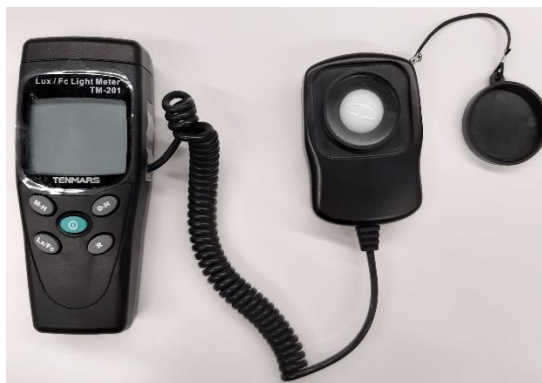
Slika 52. Tenmars TM-201 mjerač intenziteta osvjetljenja
