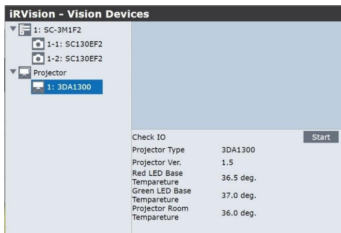
Slika 19. Korišten projektor Fanuc 3D Area senzora
