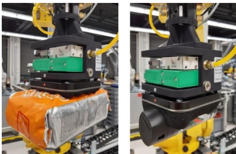
Slika 25. Prikaz hvatanja predmeta rada s Piab Kenos KCS vakuumskom hvataljkom
