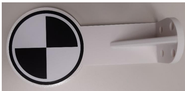
Slika 29. Konačni izgled alata za kalibraciju kamera
