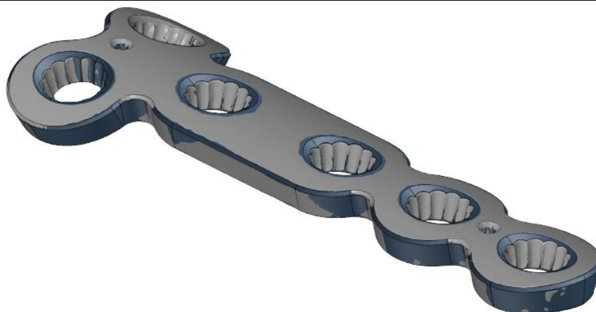
Slika 38. Preklapanje CAD modela i Mesh-a pločice
