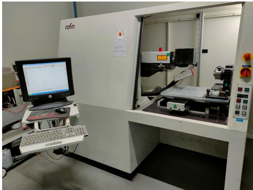
Slika 41. Uređaj za lasersko označavanje pločice
