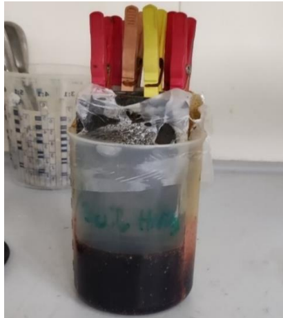
Slika 63. Uzorci uronjeni u vodenu otopinu dušične kiseline
