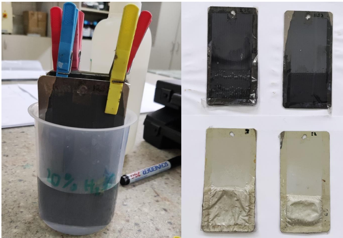
Slika 64. Uzorci u sumpornoj kiselini za vrijeme i nakon 48 sati ispitivanja
