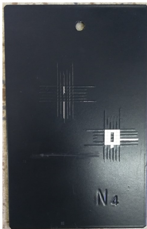
Slika 45. Primjer uzorka sa slabom prionljivošću - uzorak N4
