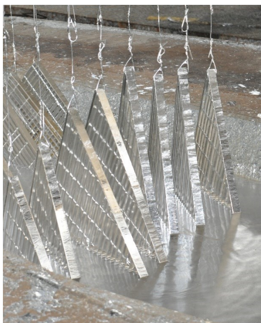
Slika 2. Vađenje obradaka iz kupke rastaljenog cinka [7]
