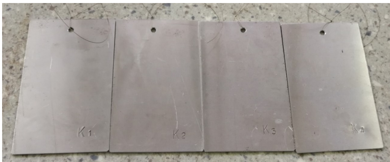
Slika 15. Uzorci obrađeni u kiselini i pasivatoru
