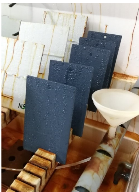
Slika 42. Uzorci nakon 480h u slanoj komori
