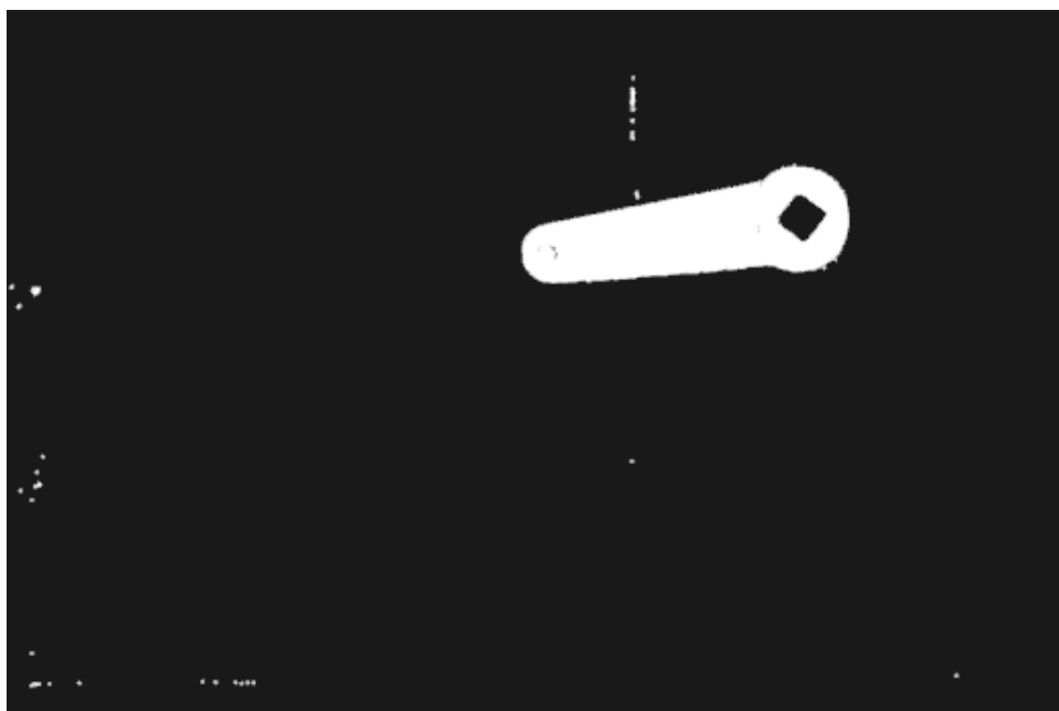
Slika 57. Oblak točaka poslije PassThrough filtra i prije segmentacije ravnine
