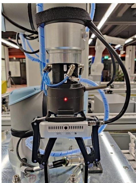
Slika 39. Hvataljka spojena na napajanje
