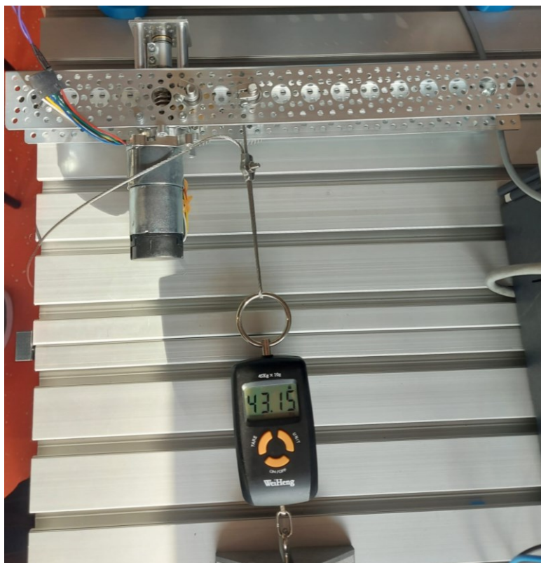
Slika 33. Testiranje sustava za namatanje sajle
