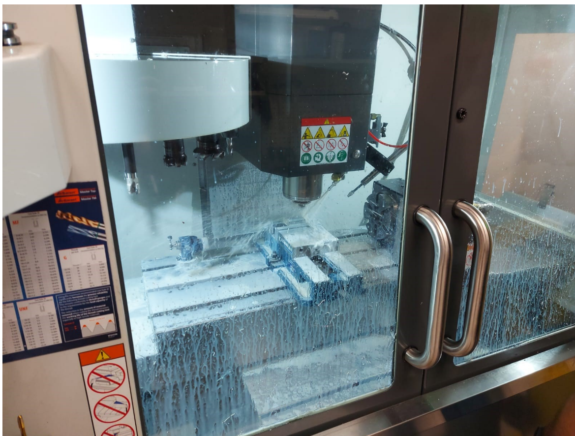
Slika 37. Izrada nosača motora na CNC stroju
