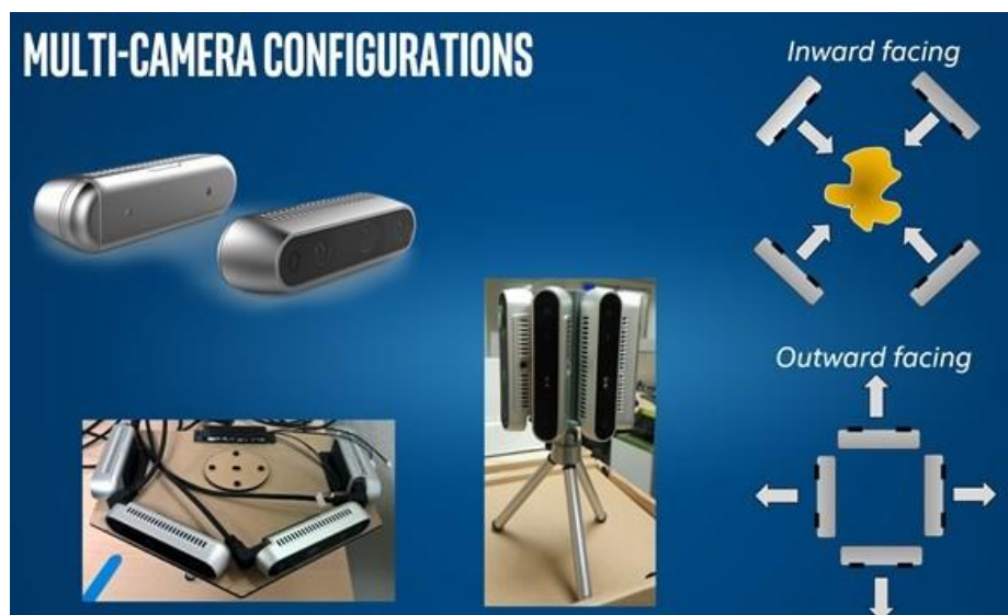
Slika 9. Neke konfiguracije Intel-ovih kamera [5]
