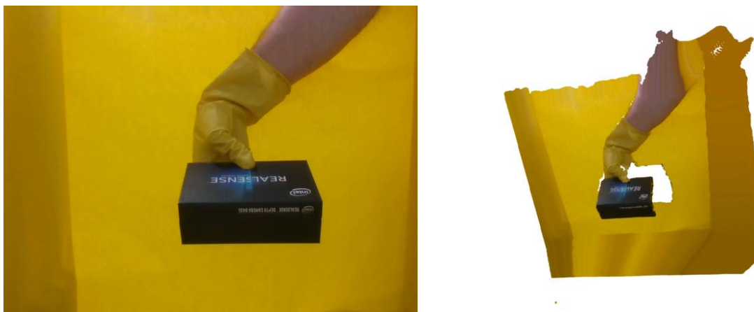
Slika 49. 2D fotografija s pripadajućim 3D oblakom točaka
