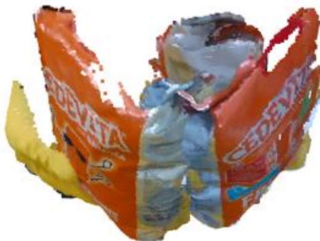
Slika 57. Oblaci točaka sa sve tri kamere prikazani zajedno
