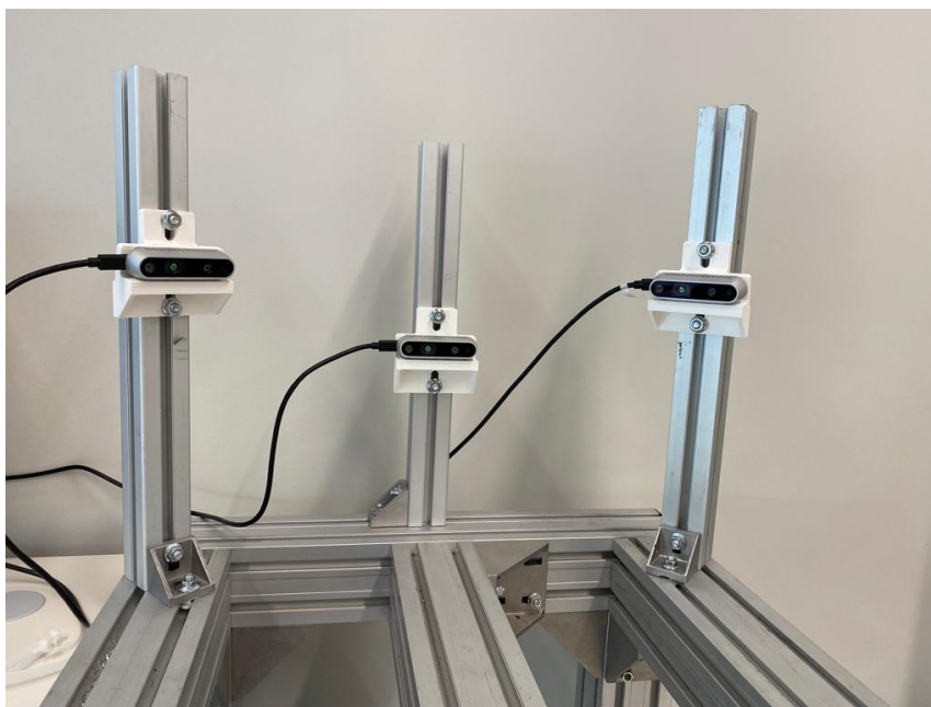
Slika 17. Laboratorijski postav – kamere montirane
