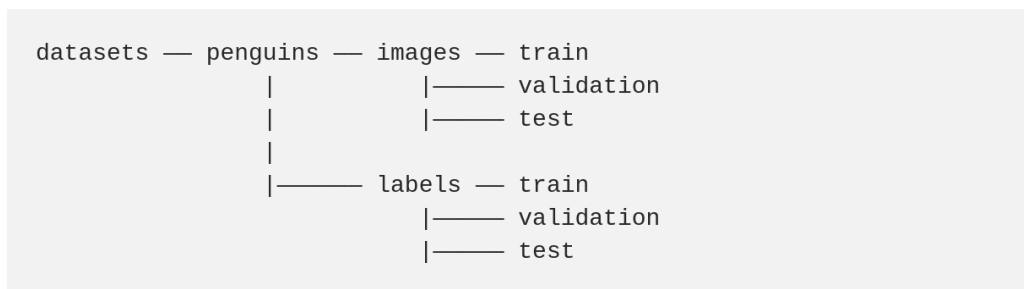
Slika 85. Struktura YOLOv5 direktorija [13]
