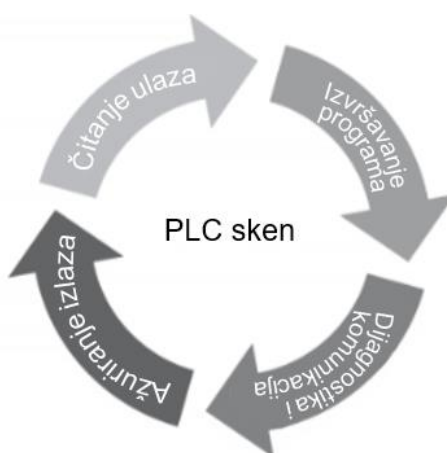
Slika 3. Ciklički rad PLC-a [4]
