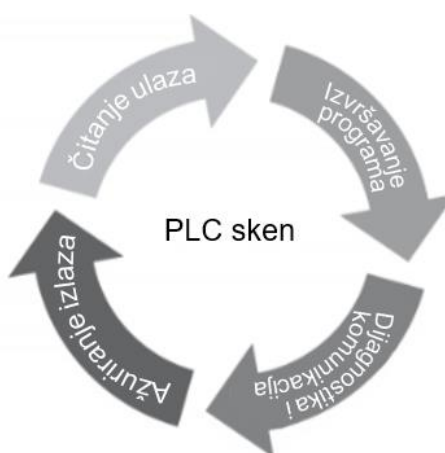
Slika 3. Ciklički rad PLC-a [4]
