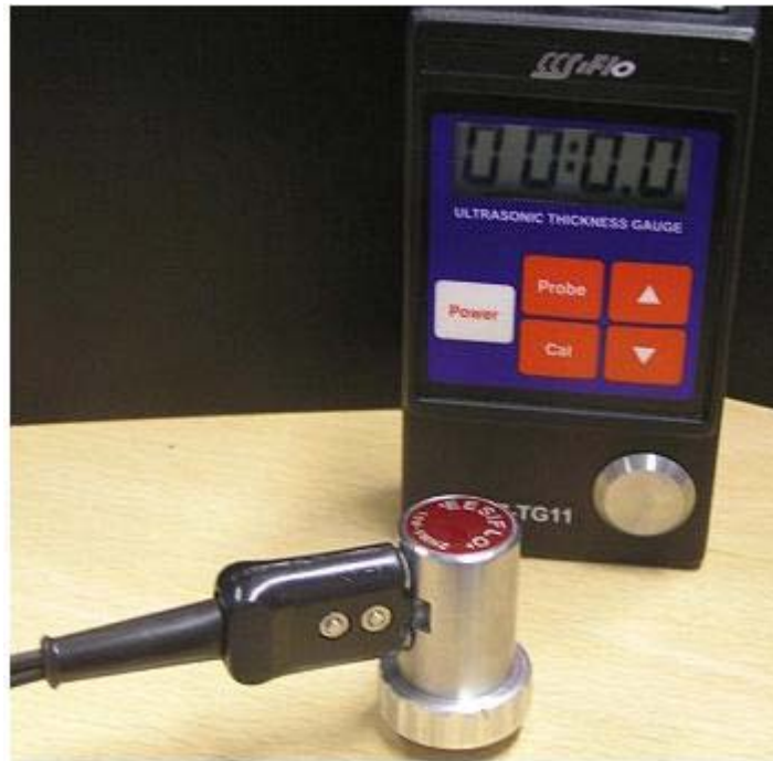
Slika 5. Ultrazvučni uređaj sa numeričkim prikazom mjerene vrijednosti
