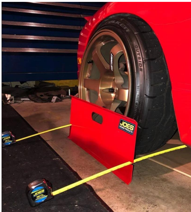
Slika 4.7. Ploče za mjerenje usmjerenosti kotača [12]
