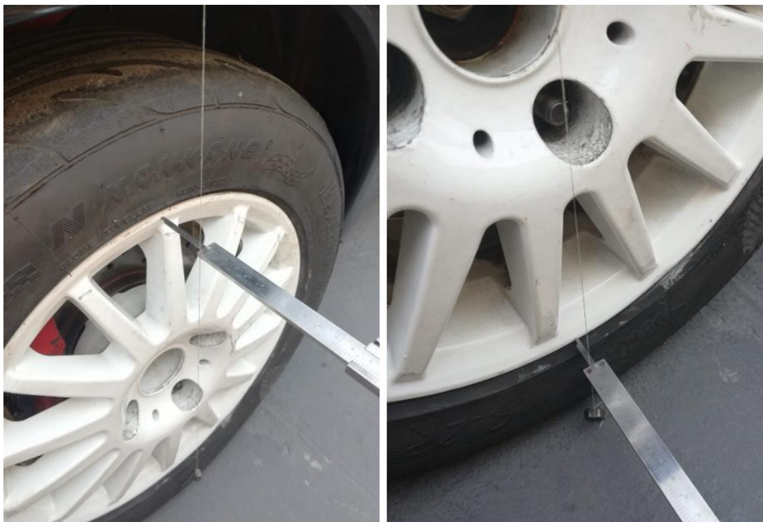
Slika 4.1. Prikaz određivanja bočnog nagiba kotača računskom metodom
