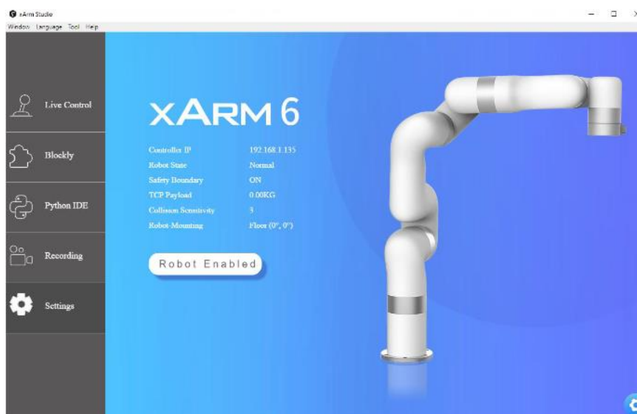
Slika 2.4 GUI aplikacija za robotsku ruku [8]
