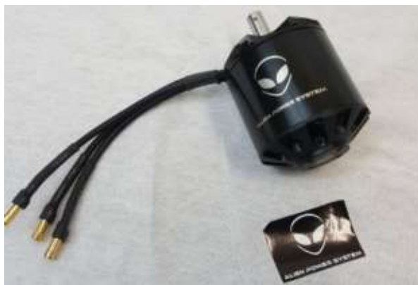
Slika 39. APS 5065 BLDC motor[29]
