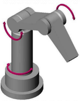
Slika 2.5. Rotacijska struktura robota
