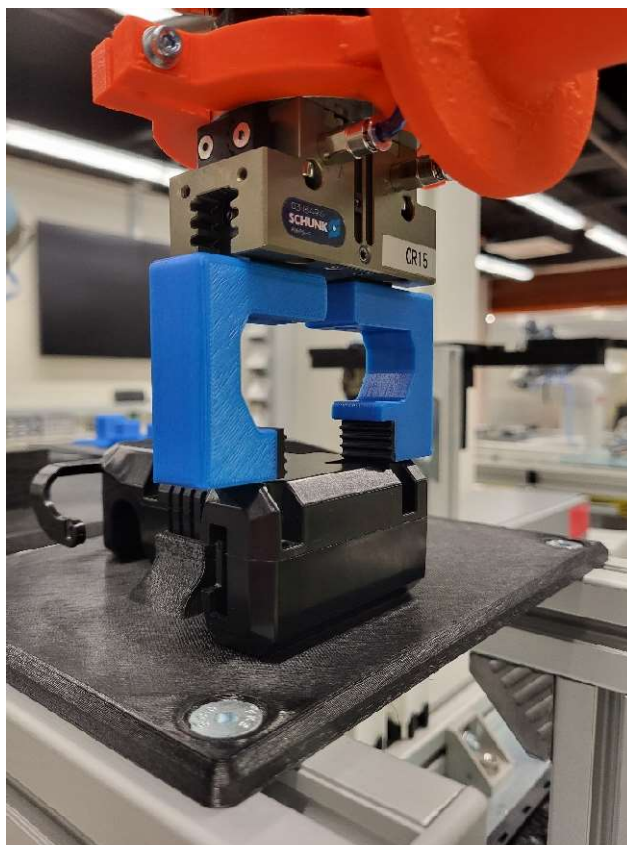
Slika 4.59. Izvršavanje funkcije kontrole sile za montažu poklopca na kućište
