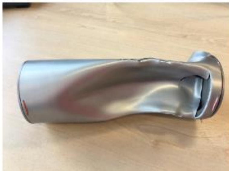
Slika 2.1. Uništeni aluminijski tank na 1000m dubine [4]
