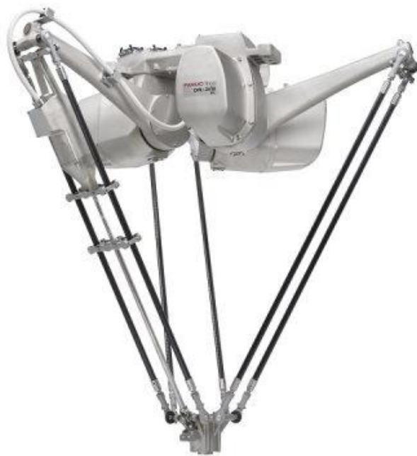
Slika 5. Fanuc DR-3iB/8L delta robot [7]
