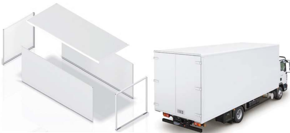
Slika 31. Zatvorena sandučasta nadogradnja od predfabriciranih elemenata [20]
