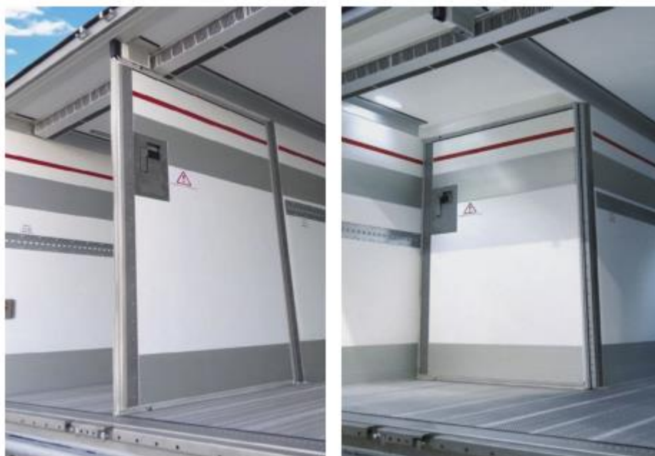
Slika 46. Pregrade unutar teretnog prostora [20]
