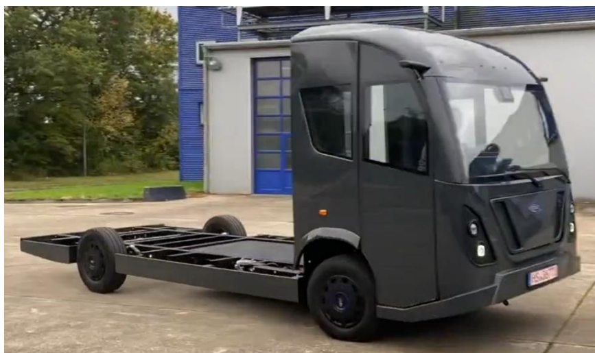
Slika 14. Prva verzija šasije dostavnog vozila CF1 [9]
