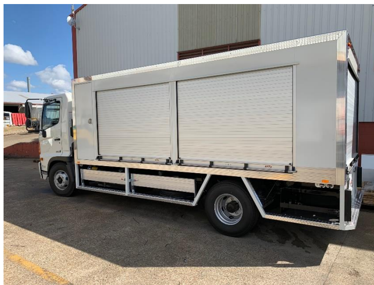
Slika 38. Stražnja rolo vrata [18], bočna rolo vrata [22]
