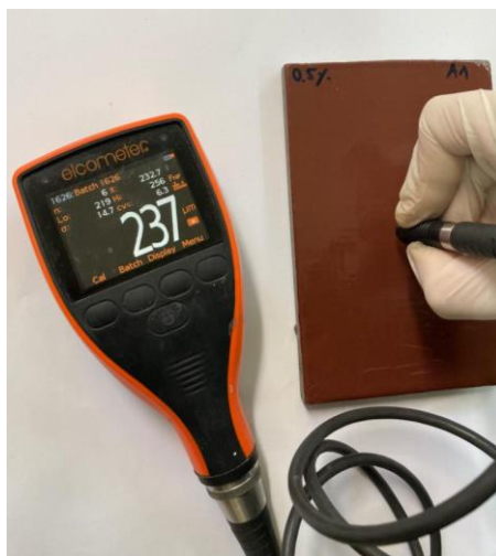
Slika 26. Postupak mjerenja debljine epoksidnog premaza
