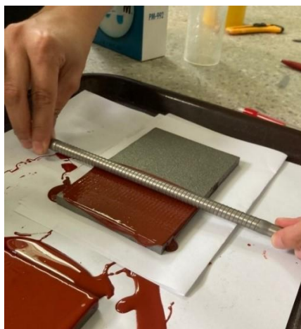
Slika 23. Nanošenje epoksidnog premaza s dodatkom nanočestica aluminija
