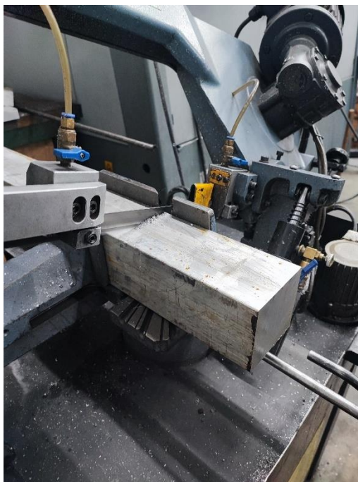
Slika 23. Rezanje sirovca na tračnoj pili
