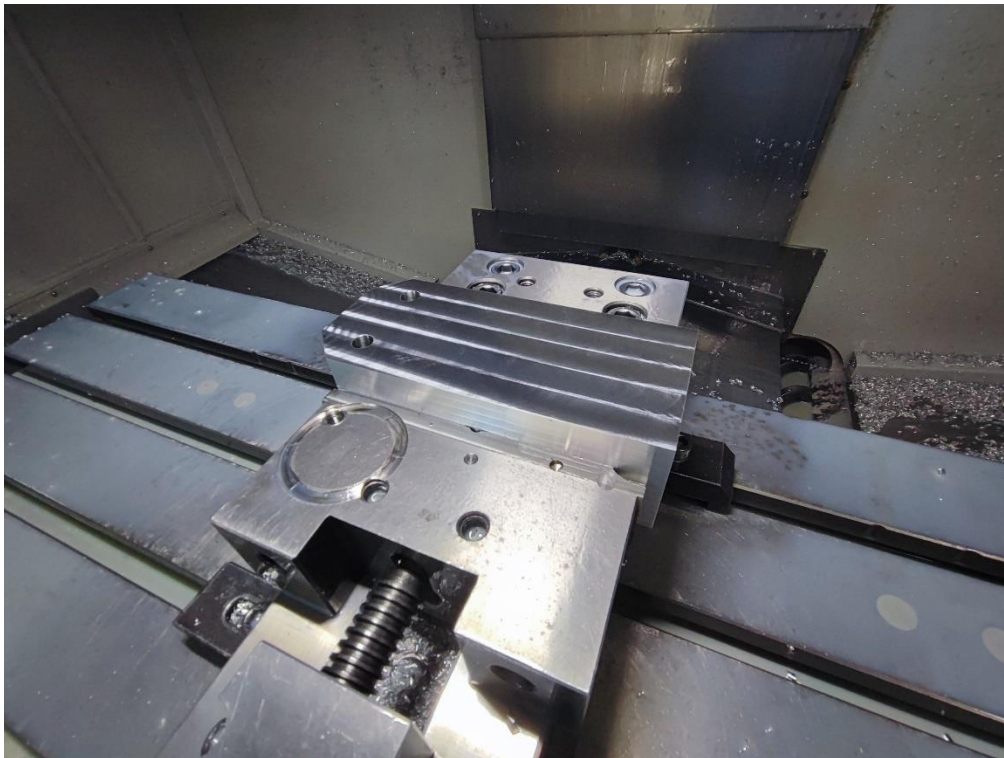
Slika 27. Komad nakon drugog stezanja
