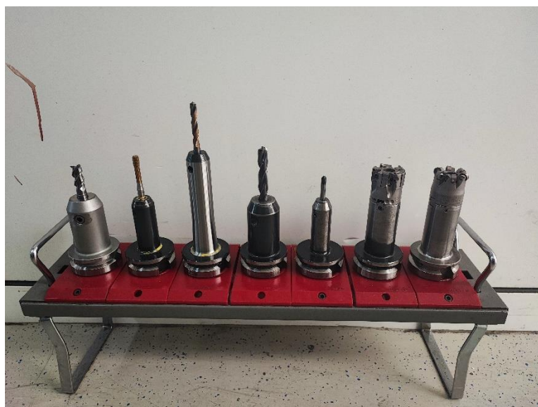
Slika 25. Korištene alati za 3-osni stroj
