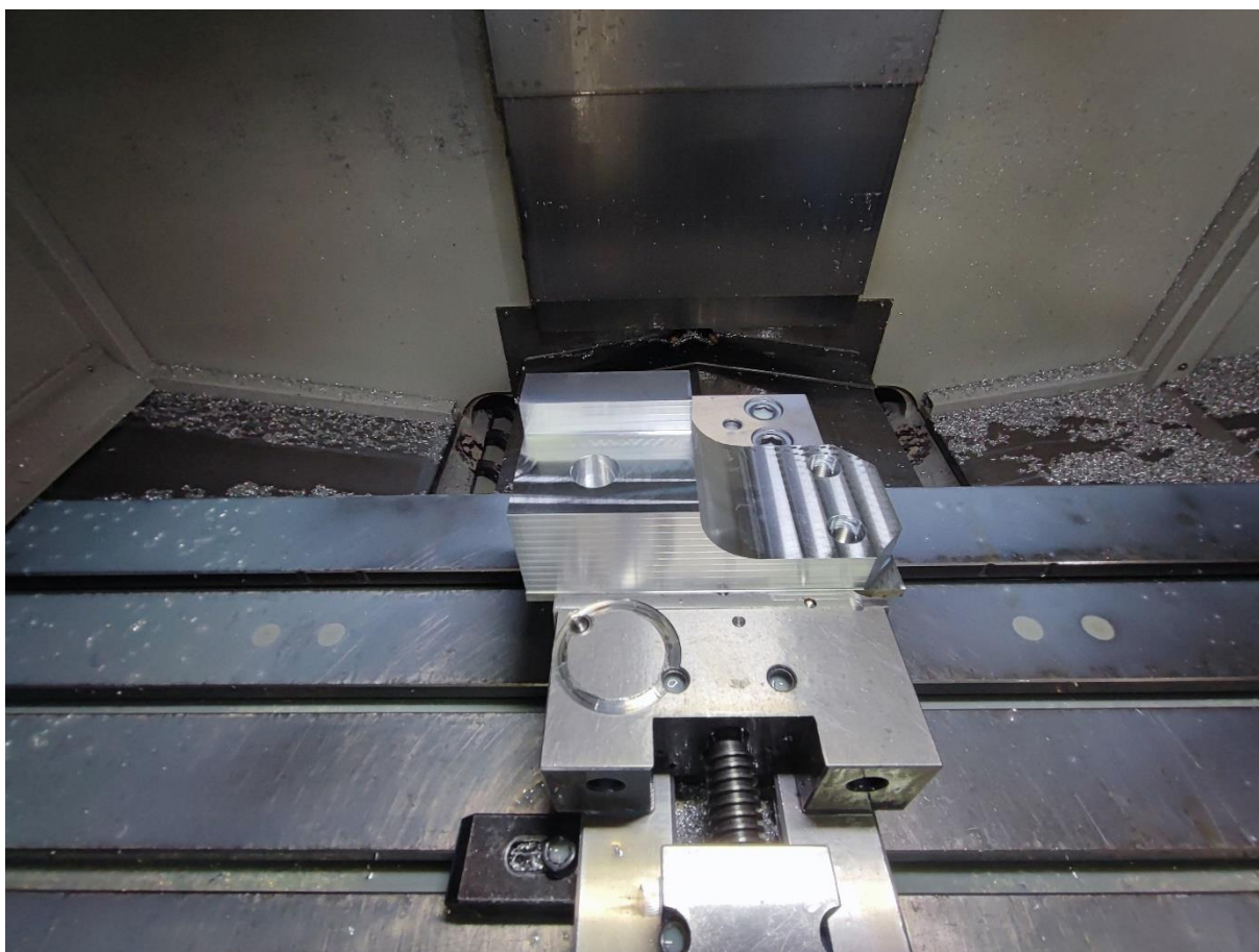
Slika 26. Komad nakon prvog stezanja
