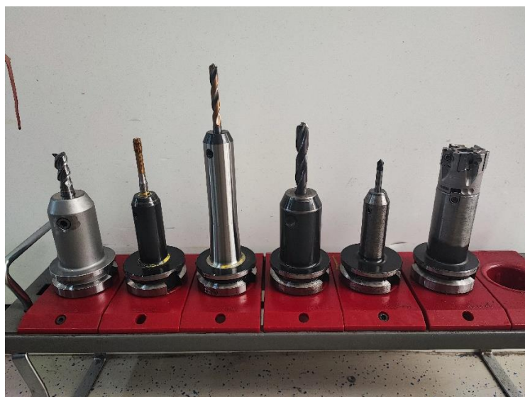
Slika 32. Korišteni alati za 5-osni stroj
