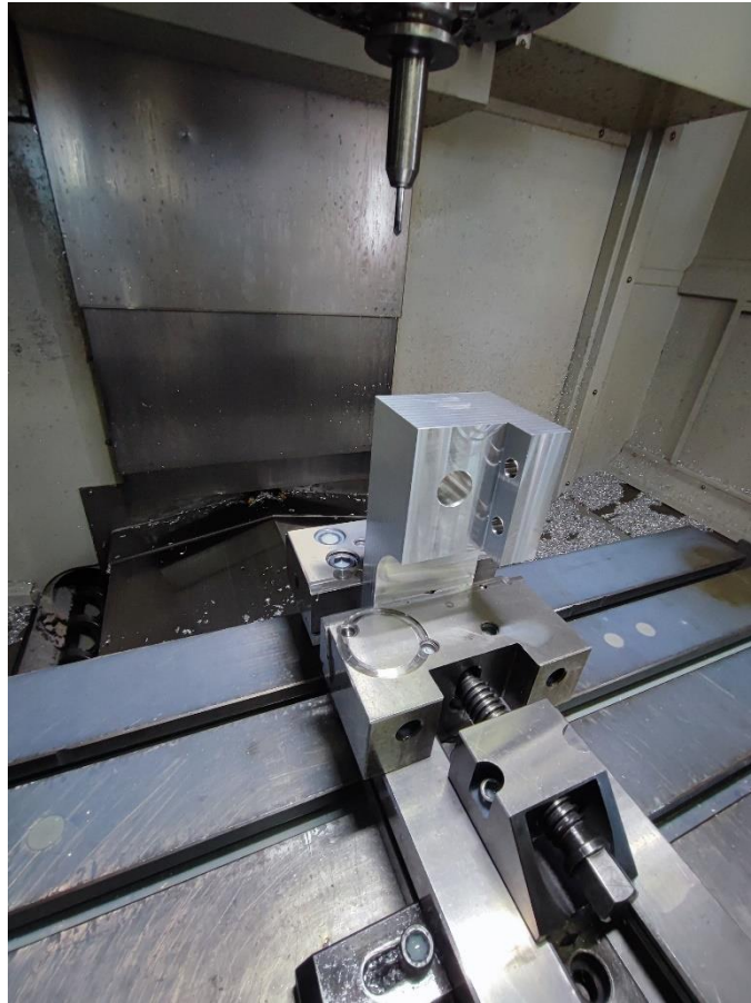
Slika 29. Komad prije četvrtog stezanja
