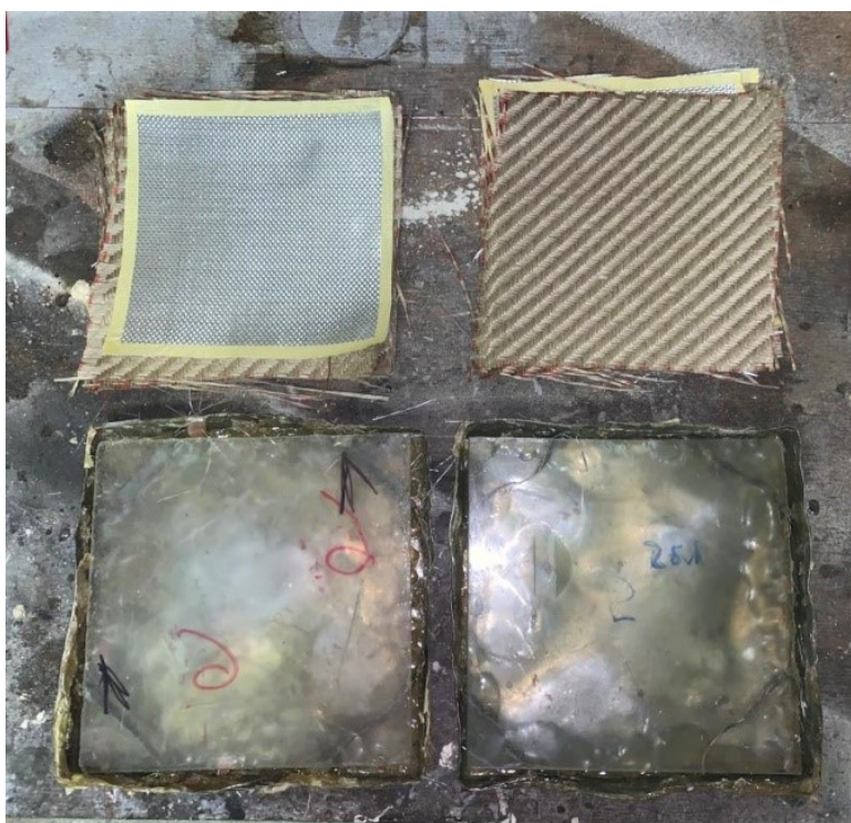
Slika 25. Priprema kompozita za ispitivanje gorivih svojstava
