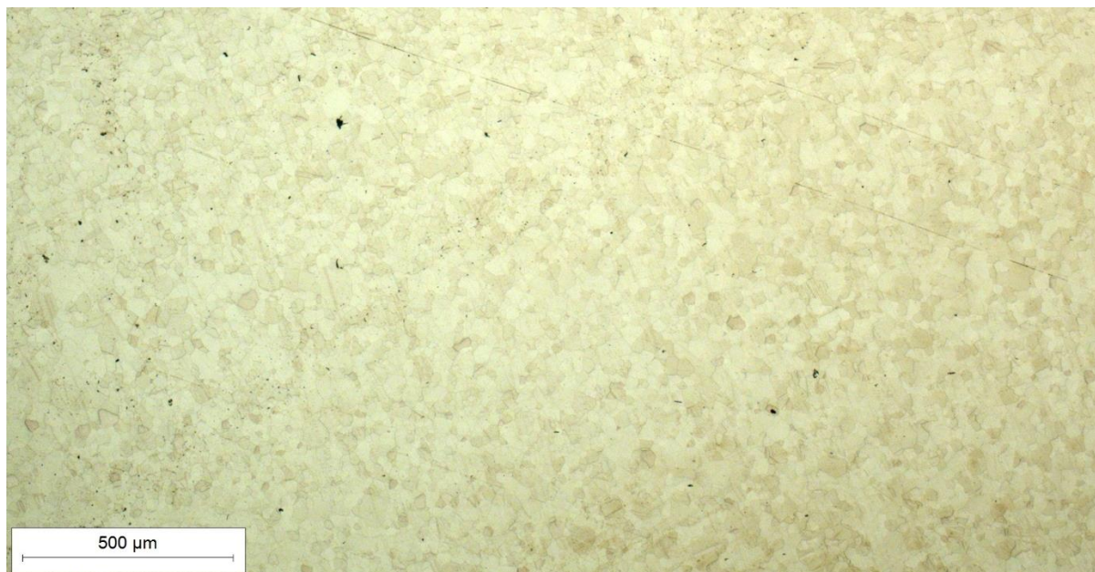
Slika 37. Mikrostruktura osnovnog materijala u nagriženom stanju, snimljeno pri povećanju 50×
