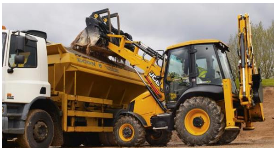
Slika 1. Bager prilikom utovara materijala na kamion [1]
