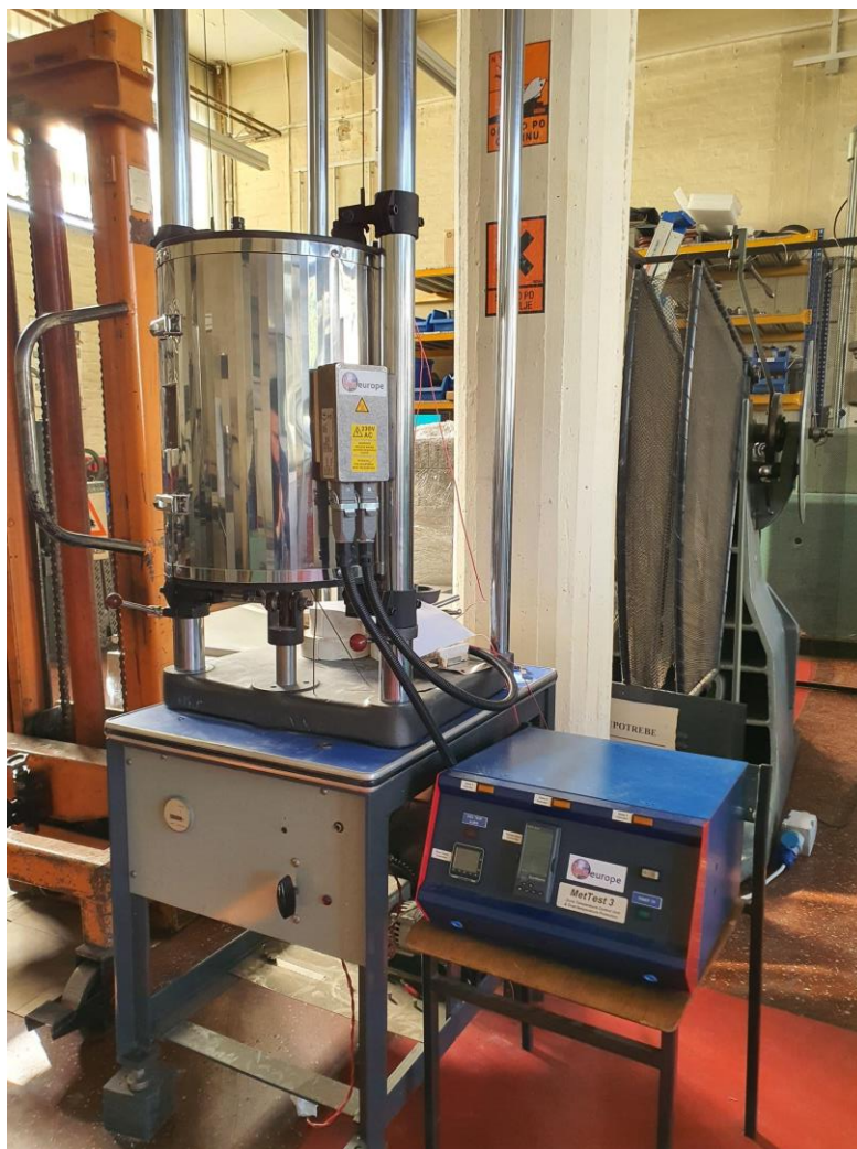
Slika 21. Toplinska komora u LIMS-u
