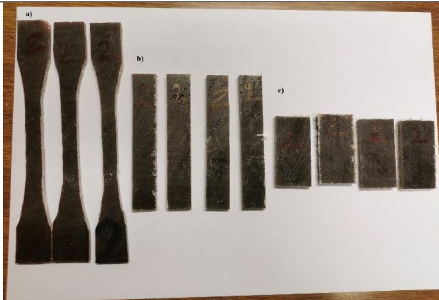
Slika 5.1 Ispitivani uzorci biokompozitnog laminata [24]
