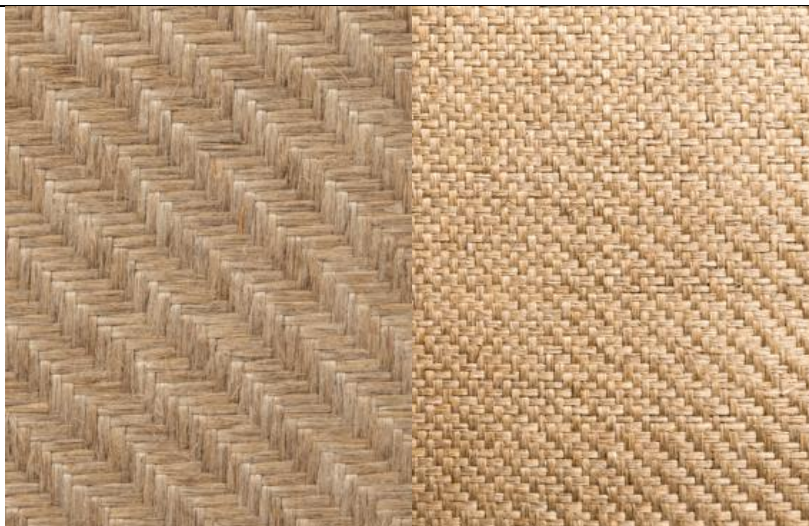
Slika 3.1 Lanena vlakna pletivo 4x4 (lijevo) i 2x2 (desno)
