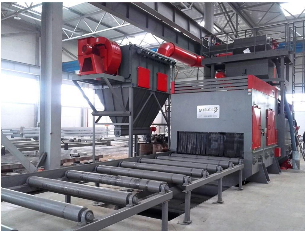
Slika 12 Protočni stroj za sačmarenje s valjkastim transporterom tvrtke Gostol TST d.d. [4]
