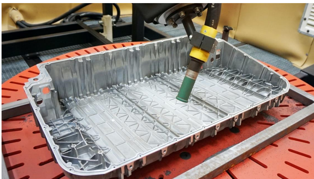
Slika 21 Automatizirani "Shot peening" dijelova za automobilsku industriju [10]
