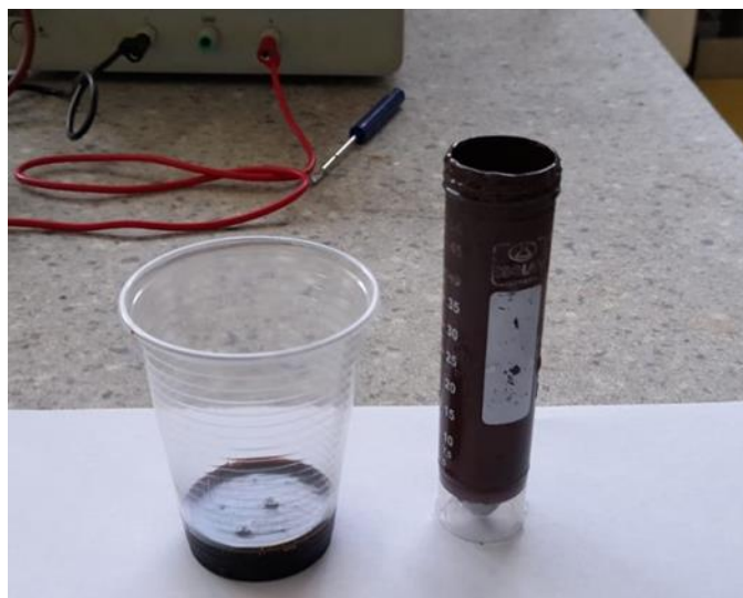
Slika 15. Epoksidni premaz sa česticama nikla i učvršćivač.
