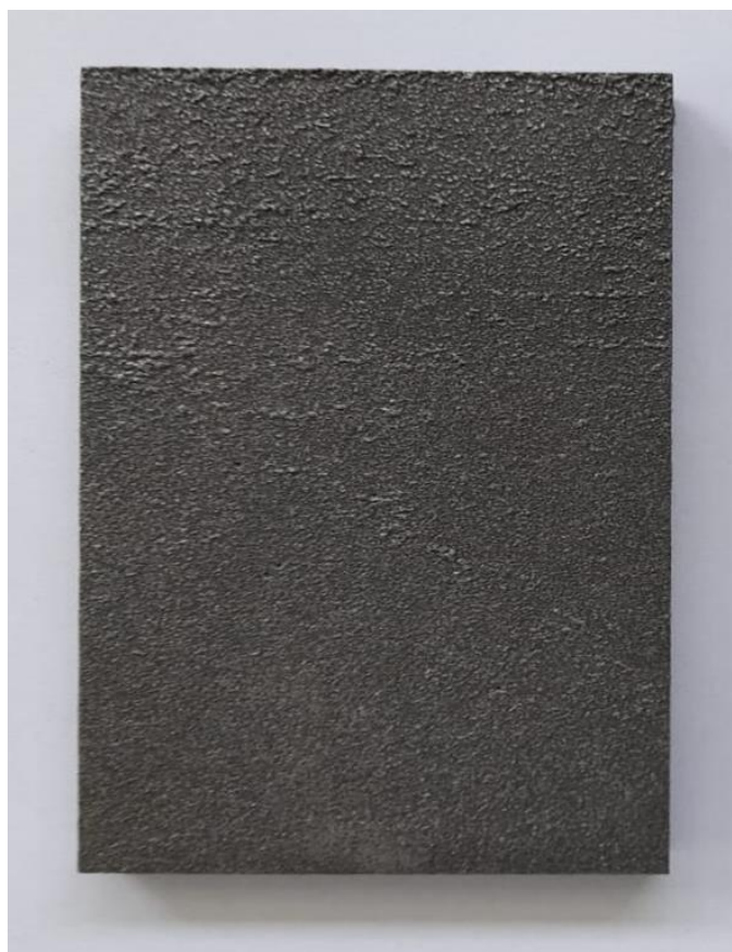
Slika 13. Uzorak sivog lijeva.
