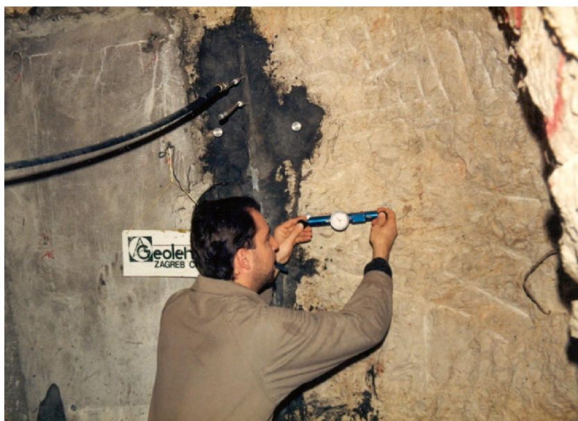
Slika 21. Mjerenje razmaka repera na površini iskopa u zoni aktivnog proreza (Karun 3, 1993)
