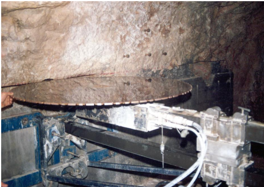
Slika 18. Rezanje lijevog pasivnog proreza. Vide se reperi za mjerenje pomaka u zoni aktivnog proreza (Karun 3, 1993).
