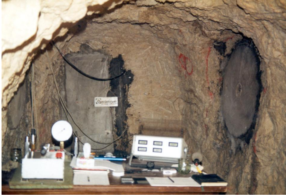
Slika 22. Tlačni jastuk u čelu niše postavljen paralelno sa slojevima. Vide se obrađene površine za pokus pločom (Karun 3, 1993)
